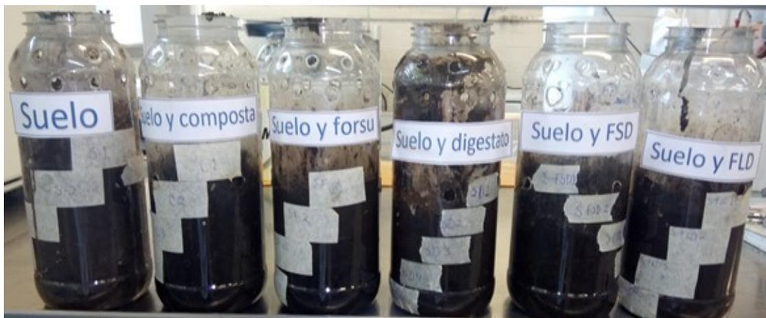
Figura 3.12 Contenedores para la toma de muestra y construcción del perfil de concentraciones de amonio y nitratos
