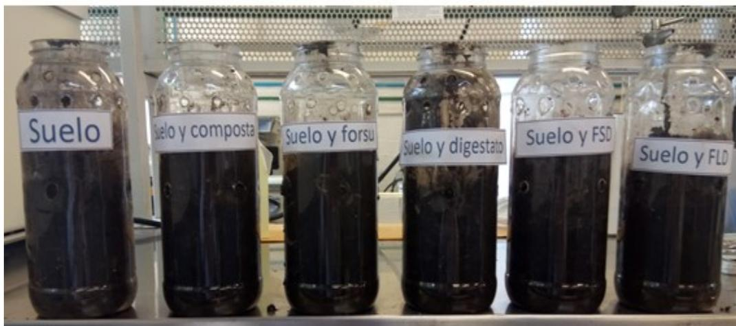
**Figura 3.11 Contenedores y materiales agregados al suelo en el experimento de incubación**
