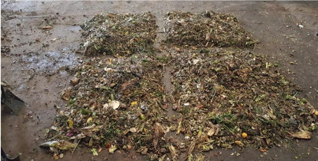
**Figura 3.4 Residuos divididos en 4 partes como lo indica el Método de Cuarteo**
