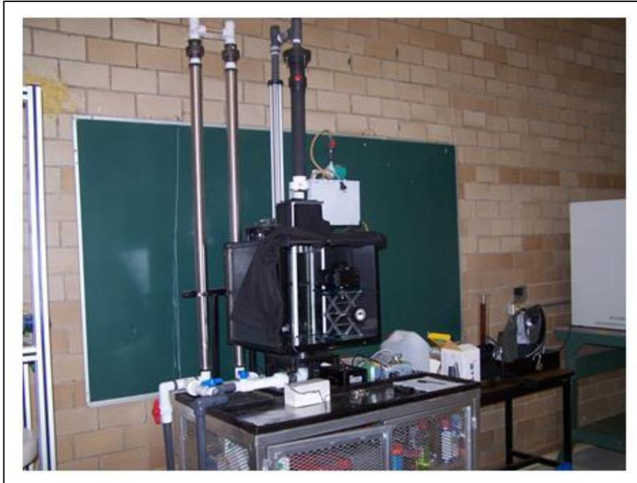
*Figura 2.1.5-3 Cámara oscura montada para lograr la visualización de los vórtices*
