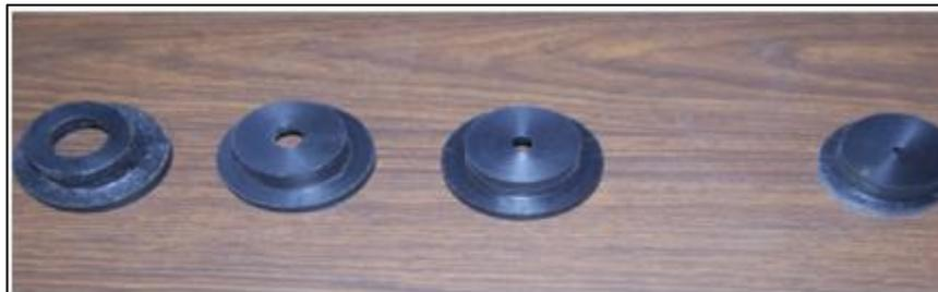
*Figura 2.1.2-1 Placas de contracción expansión*
