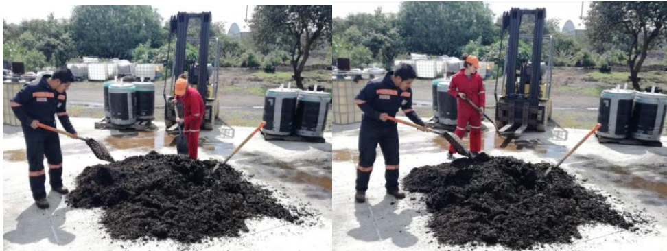
Figura 15. Secado al Sol de la astilla de madera utilizada para la producción del biocarbón.
