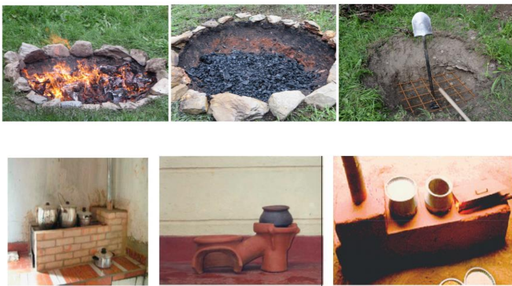
Figura 2. Producción de biocarbón en un horno de 90 cm de profundidad con una circunferencia de piedras en la superficie, fotos tomadas de (Schmidt & Taylor, 2021). Ejemplos de estufas pirolíticas, fotos tomadas de (Manoj Kumar et al., 2013)
