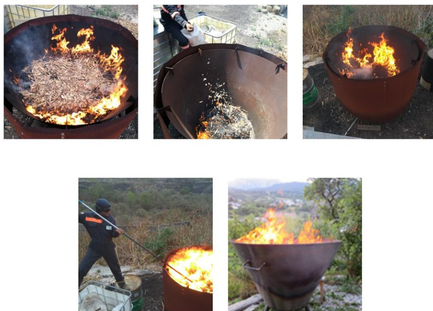
Figura 3. Producción de biocarbón en un Kon-Tiki de acero, fotos tomadas en la Planta de Gasificación UNAM SAGARPA G2E, última foto tomada de (Schmidt & Taylor, 2021).
