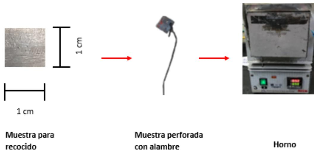
Figura 6-5. Acondicionamiento de muestras para el tratamiento térmico.
