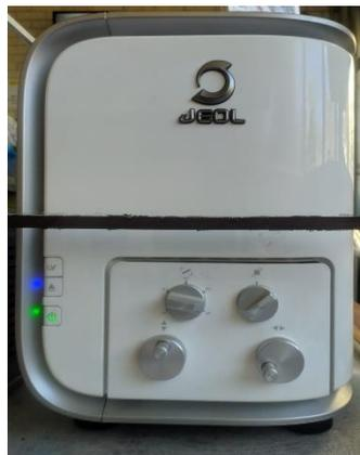
Figura 6-6. Microscopio de barrido electrónico utilizado para analizar la microestructura y EDS.
