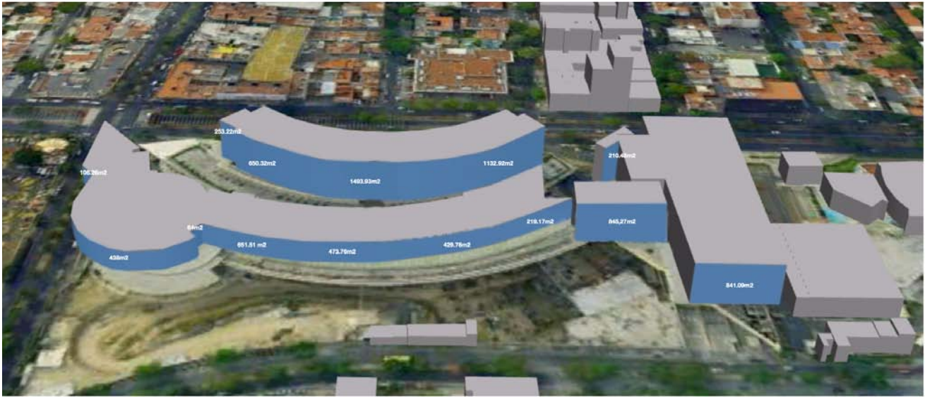
Figura 90. Áreas parciales de fachada sur obtenidas por medio de Google Earth. Centro Comercial Antara. Imagen con intervención propia.
