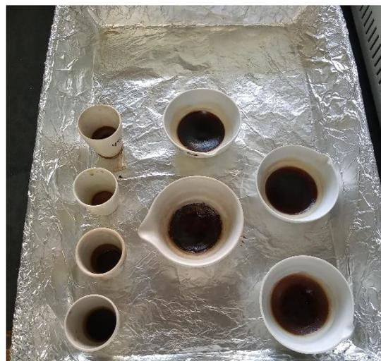
**Figura 3.8. Muestras al momento de salir de la estufa después del proceso de evaporación**
