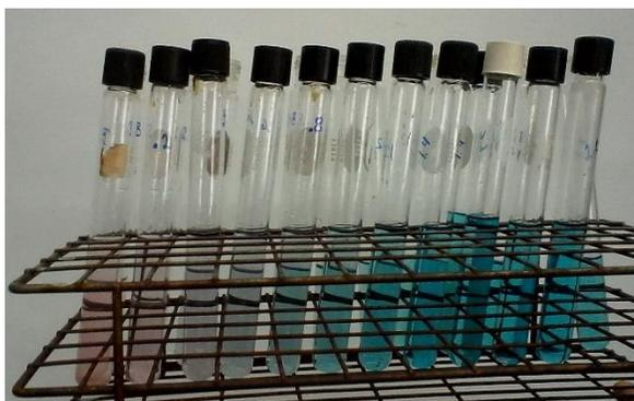
**Figura 3.6. Muestras de la curva de calibración de la técnica de azul de metileno para determinar sulfuros**
