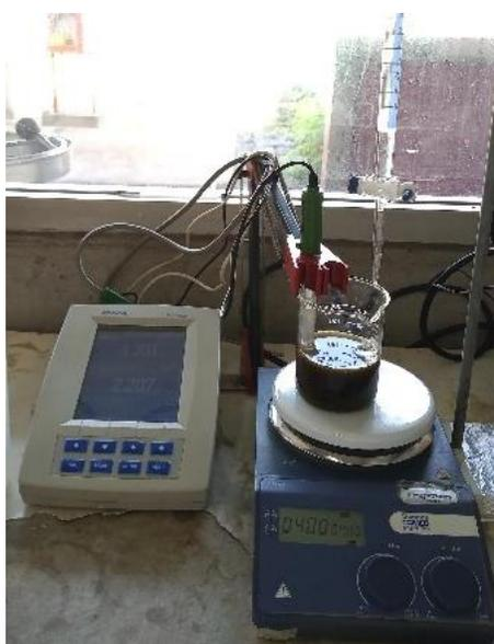
**Figura 3.5. Sistema utilizado para a determinación de alcalinidad**
