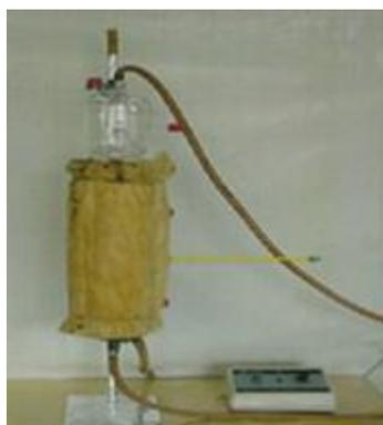
**Figura 3.2. RALLFA alimentado en la parte inferior mediante una bomba peristáltica (Rincón-Acelas, 2008)**
