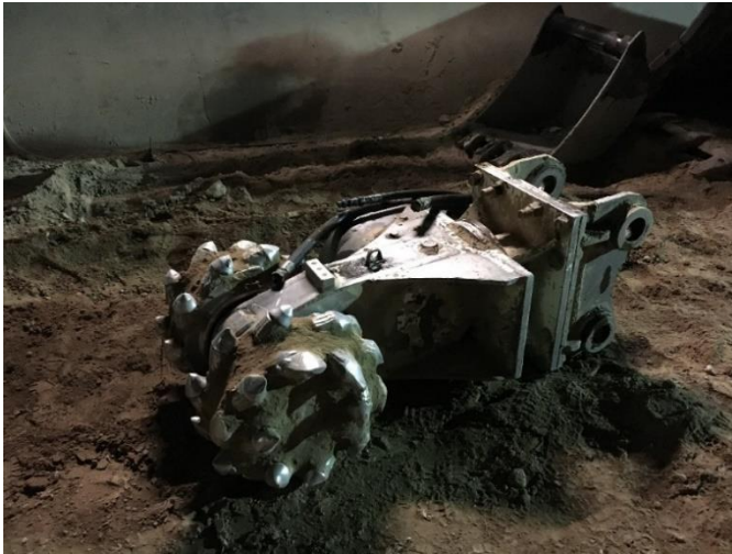
Ilustración 9. Cabeza de rozadora utilizada en las obras de ampliación de la línea 12 del metro CDMX.
