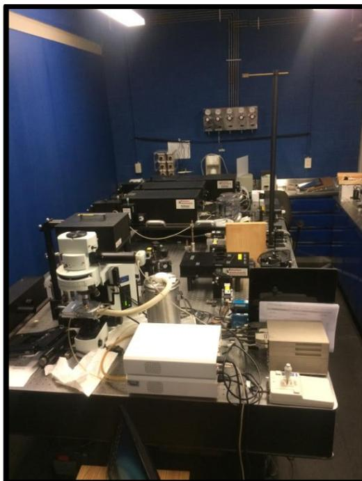
Figura 15. Espectrómetro Raman Trivista de alta resolución ( $0.67 \text{ cm}^{-1}$ ) Princeton Instrument Model 557 en configuración monovista, ICAT, UNAM.
