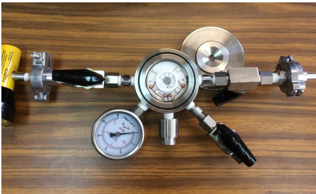
Figura 41. Celda Termo-Óptica con las conexiones de vacío, eléctricas y de presión, antes de realizar las primeras pruebas.
