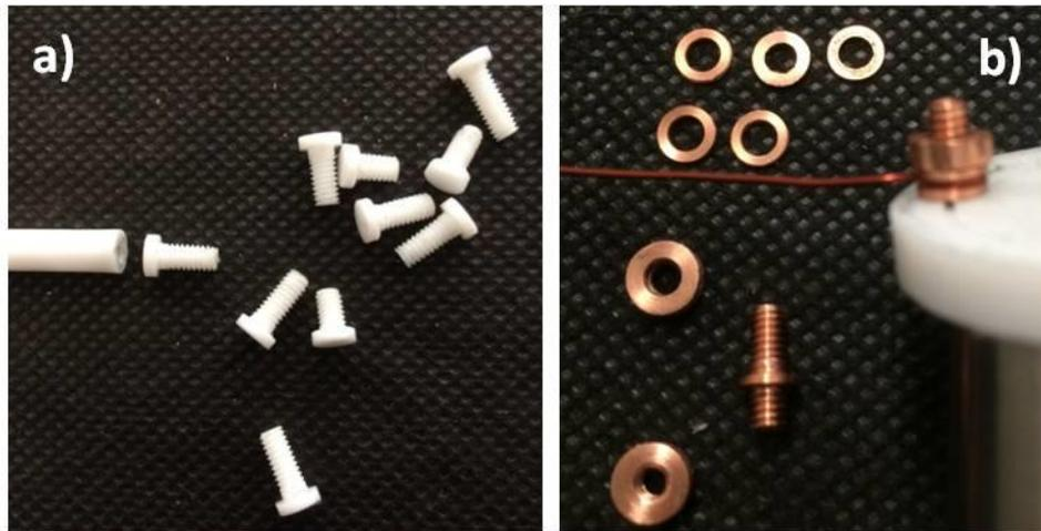
Figura 37. Tornillos de teflón de 1/8" de diámetro y cuerda de 40 hilos por pulgada, con cabeza para destornillador plano (a). Postes con rondanas y tuerca de ajuste, todos de cobre (b).
