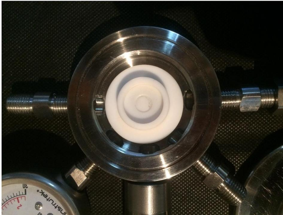
Figura 34. Cuerpo de la celda con los 5 barrenos con cuerda interna NTP  $\frac{1}{4}$  para conexión de llaves, vacío, medidor de presión y atravesador eléctrico.
