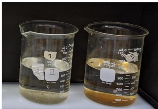
Figura 4.3 Flóculos formados con el coagulante comercial cloruro férrico
