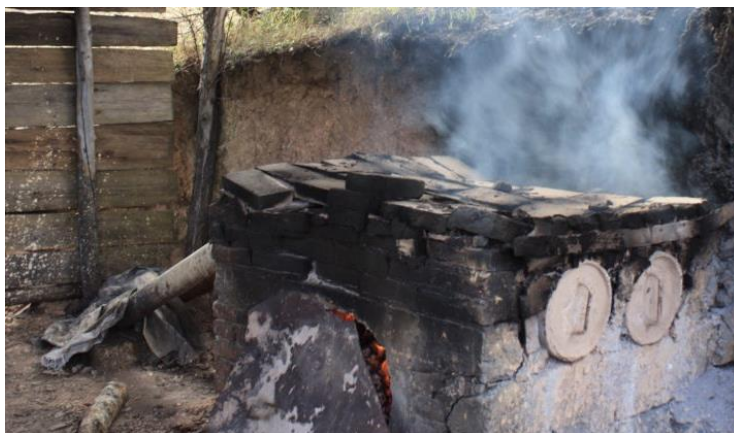
Figura 2.5 Hornos utilizados en la MAPE para extracción de mercurio (de la Torre, 2017).
