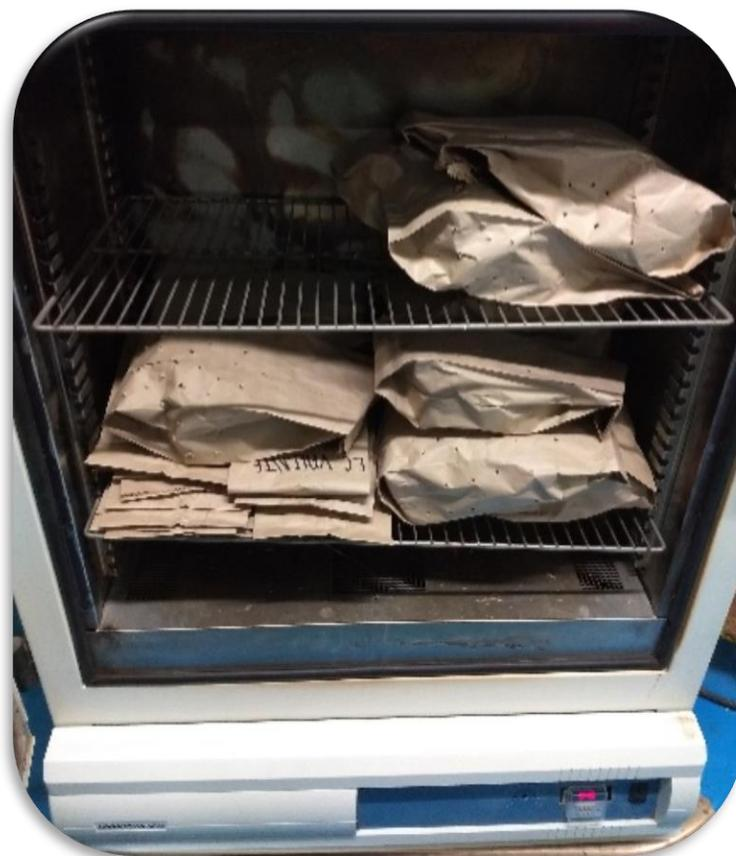
*Figura 11. Deshidratación de muestras a  $50^{\circ}\text{C} \pm 5^{\circ}\text{C}$ . Berrocal, R. (2019).*
