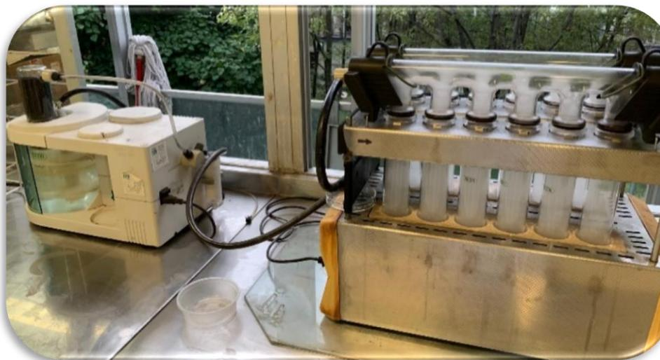
*Figura 15. Digestor conectado a trampa. Berrocal, R. (2019).*
