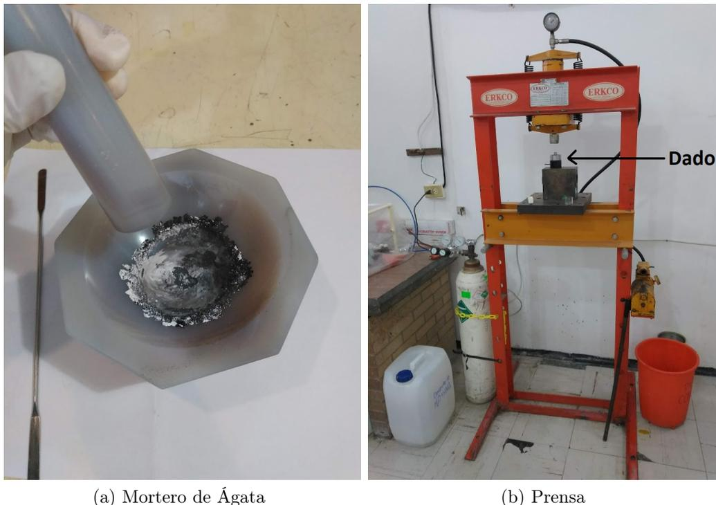
Figura 3.1: (a)Mortero de ágata y (b) Prensa, utilizados para la conformación de las muestras.
