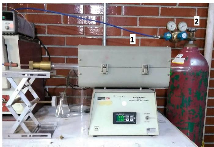
Figura 3.3: Horno utilizado para la oxigenación de las muestras [1.Horno tubular, 2. Tanque de Oxígeno conectado para que oxigene la muestra.]
