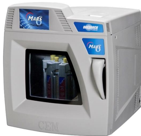
Figura 3.2. Equipo CEM, modelo MARS 6 ONE TOUCH donde se sintetizó la solución sólida deseada por el método hidrotérmal asistido por microondas.
