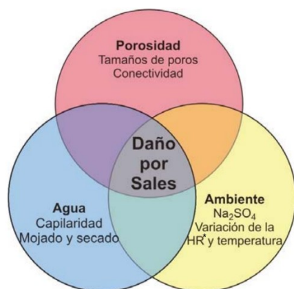
Figura 5 Condiciones para que exista el daño por cristalización de sales, en donde HR es la humedad relativa. Modificado de Irassar E. et al, 2010.
