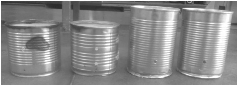
Figura 9. Imagen de las 4 latas usadas para los moldes, los moldes para detectar la señal con rechupes se hicieron con latas con una altura de 8.23cm y diámetro de 8.46cm y los moldes para detectar la señal sin rechupes se hicieron con latas con una altura de 11.4cm y un diámetro de 8.58cm.
