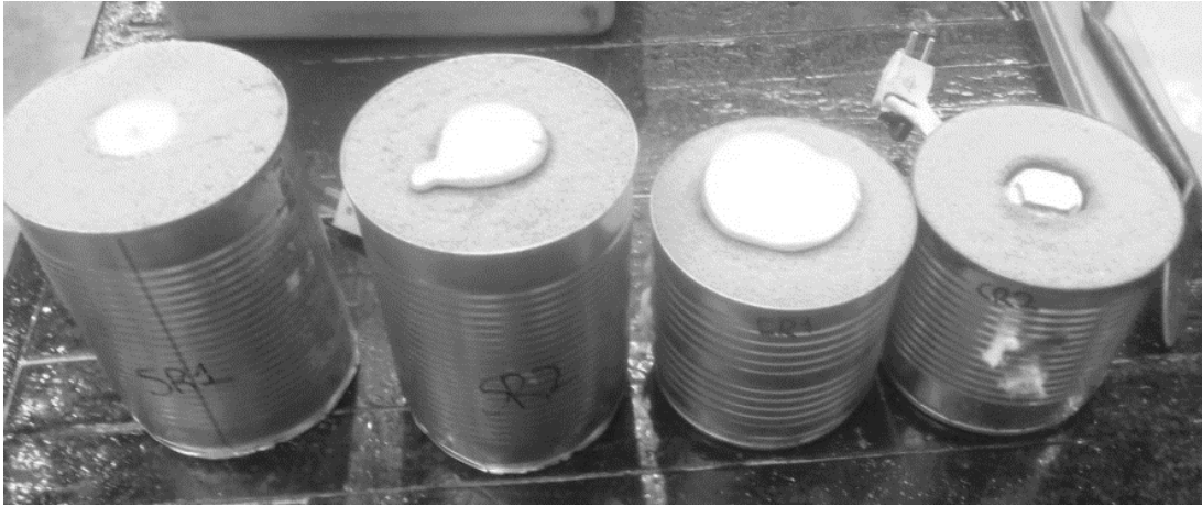
Figura 16. Imagen de los moldes y las piezas, al día siguiente de un experimento, antes de desmoldearlas.
