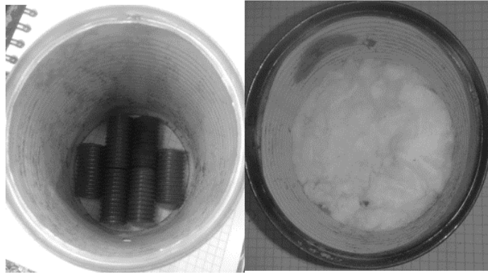
Figura 11. Imagen del fondo de las latas, en donde se observa cómo se colocan las cuerdas de probetas de tensión de cobre y la fibra aisladora, para su respectivo molde.
