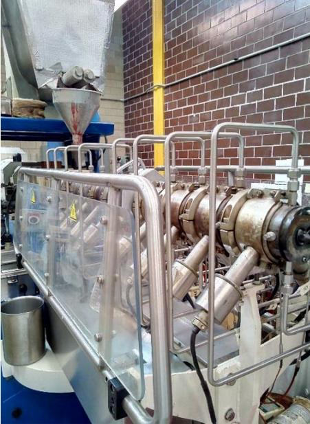
Foto 9. Extrusor de doble tornillo.
