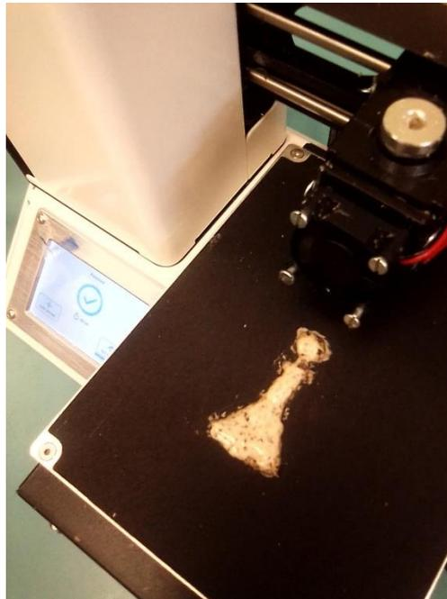
*Foto 19. Impresión en 3D de Formulación alginato-almidón-aislado de proteínas de BSG*
