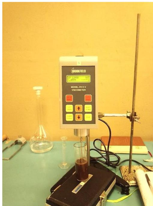
*Foto 16. Equipo para la determinación de la viscosidad.*
