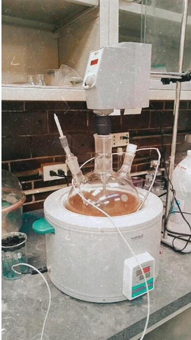
*Foto 11. Equipo para hidrólisis alcalina.*
