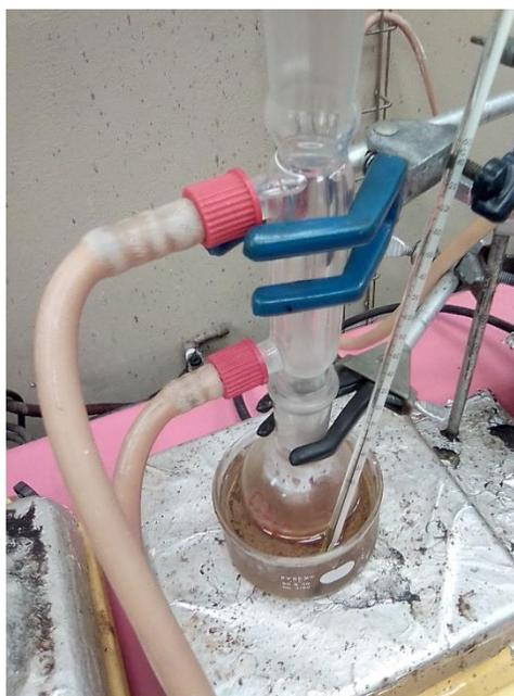
*Foto 8. Equipo de calentamiento (similar para tratamiento hidrotermal y tratamiento alcalino).*
