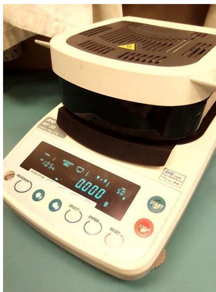
*Foto 2. Termobalanza para determinación de humedad.*
