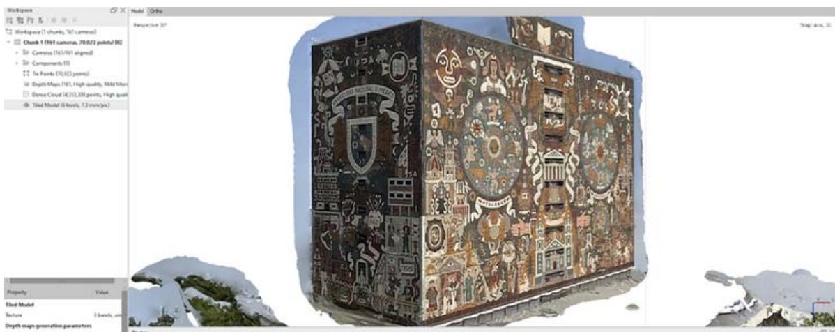
Imagen 12. Levantamiento de fachada Biblioteca Central procesada en Agisoft Metashape Professional. Acercamiento a dos fachadas vistas desde Rectoría. Ubicación: Campus Ciudad Universitaria. Trabajo de: Gutiérrez Díaz, A. Taller de Fotogrametría, (2021). PAPIME.
