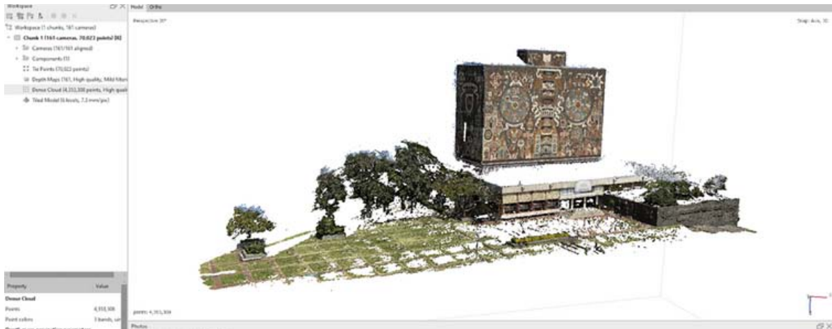
Imagen 10. Levantamiento de fachada Biblioteca Central procesada en Agisoft Metashape Professional. La nube de puntos se vuelve densa, dando los primeros indicios de color, forma y textura. Ubicación: Campus Ciudad Universitaria. Trabajo de Alejandra Gutiérrez Díaz, taller de Fotogrametría, PAPIME.
