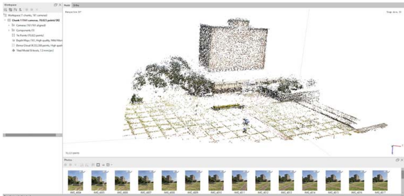
Imagen 9. Levantamiento de fachada Biblioteca Central procesada en Agisoft Metashape Professional. En el lado inferior de la ventana de trabajo se pueden ver las fotografías secuenciales tomadas (161 en total). En el espacio de trabajo se observan los puntos que forman la base del modelo. Ubicación: Campus Ciudad Universitaria. Trabajo de Gutiérrez Díaz, A. Taller de Fotogrametría, (2021). PAPIME.
