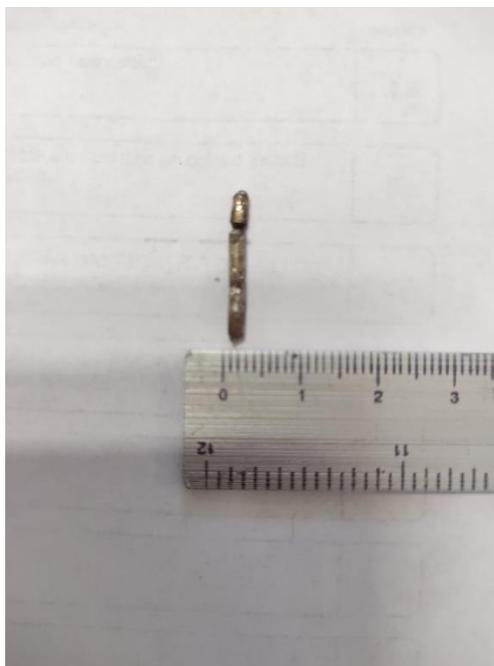
Figura 16c. Cilindro o tubo obtenido por fundición de arco eléctrico y succión en molde de cobre (visto de manera vertical).
