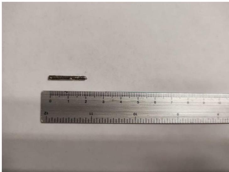
Figura 16b. Cilindro o tubo obtenido por fundición de arco eléctrico y succión en molde de cobre (visto de manera horizontal).
