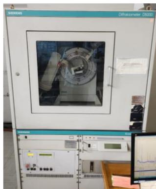
Figura 18. Difractómetro D5000.
