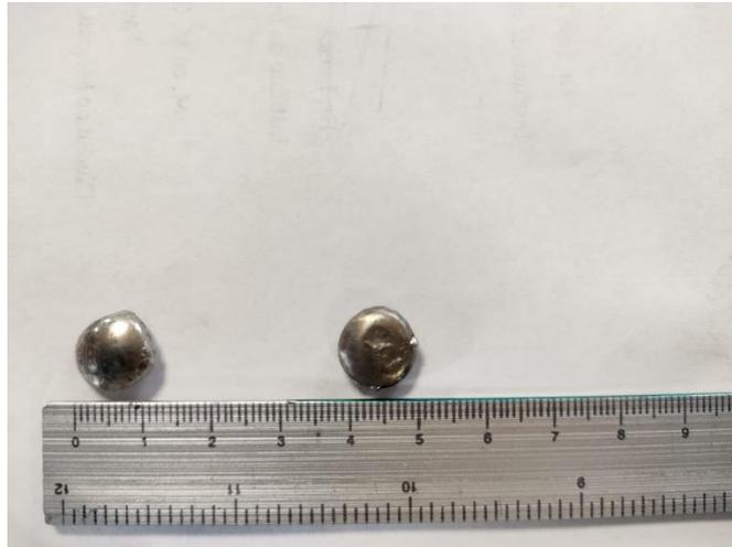
Figura 16a. Lingote de MnBi obtenido por arco eléctrico
