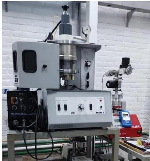
Figura 15. Horno de arco eléctrico utilizado
