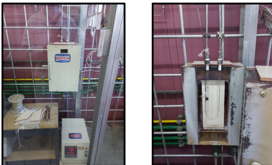
FIGURA 26 REACTOR EN FORMA DE "U" Y CONTROLADOR DE TEMPERATURA MARCA ENSA.
