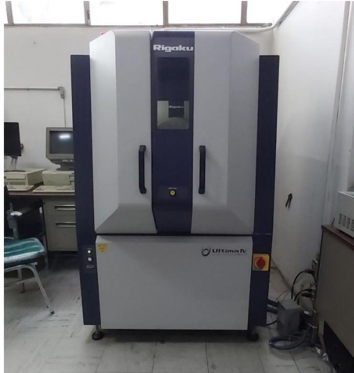
**Figura 15.** Difractómetro de rayos X Rigaku Ultima IV en donde se analizaron los recubrimientos sin y con tratamiento térmico
