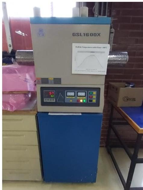
**Figura 14.** Horno tubular donde se realizaron los tratamientos térmicos de los recubrimientos
