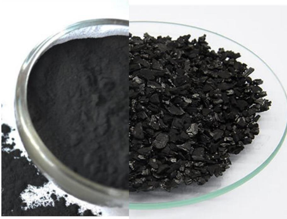
Figura 16: Carbón activado en polvo (CAP) y carbón activado granular (CAG), utilizados en el tratamiento de aguas (Carbons, 2022).
