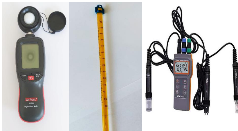
Figura 3. Instrumentos de referencia. La comprobación del funcionamiento del multiparámetro AQ_FESZ se utilizaron instrumentos de referencia, los cuales contemplan lecturas estándares en un sistema arrecifal.
