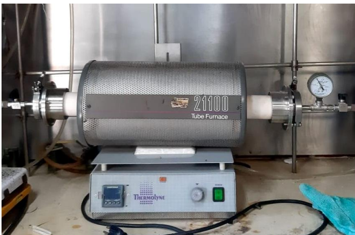
Figura 3.2 Horno tubular con atmósfera controlada utilizado para la síntesis de los cerámicos.
