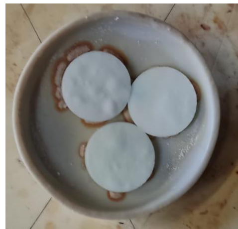
Figura 3.3 Muestras sin contenido Ni obtenidas después del proceso de calcinación.
