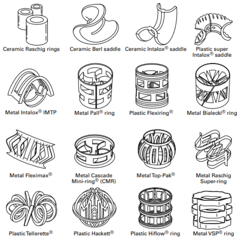
Figura 16: Empaques de relleno para columnas empacadas (Seader, Henley, & Roper, 2011).
