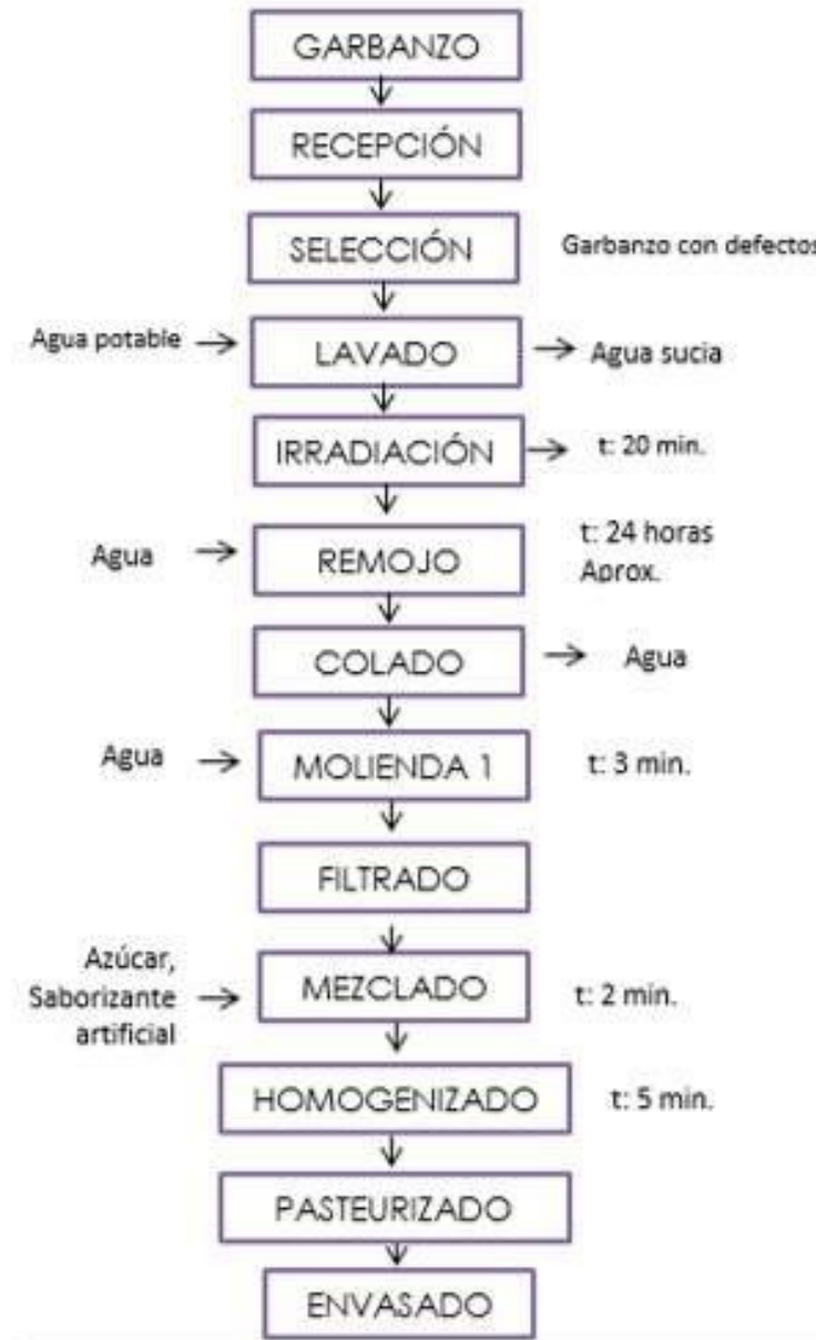
Figura 25. Diagrama de bloques para la elaboración de una bebida vegetal de garbanzo con saborizante de nuez.
