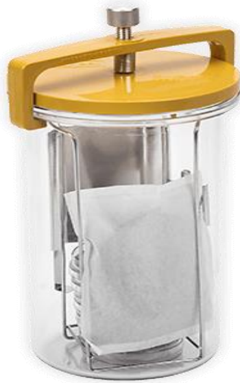
Figura 16. A. Jarra de anaerobiosis, generada con sobre GasPak™ EZ, y/o c GasPak™, B. Jarra de anaerobiosis incubada a 37±0.5°C.
