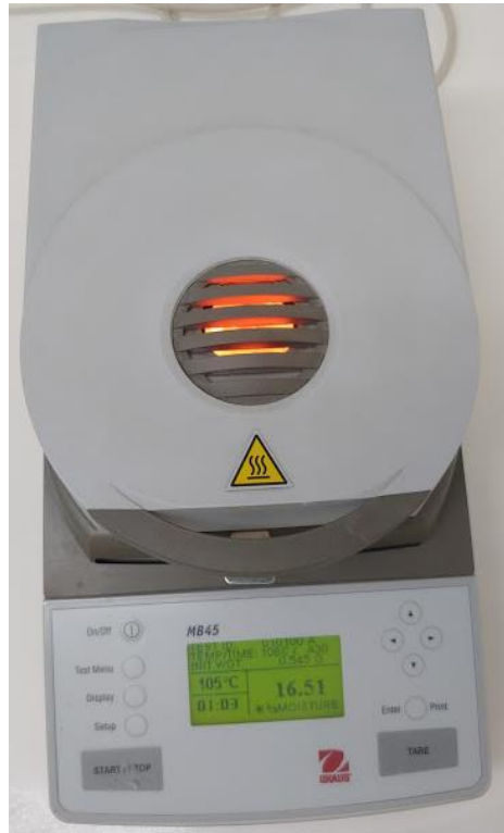
Figura 20. Termobalanza (marca OHAUS, modelo MB45) en funcionamiento Foto tomada en la FESC.
