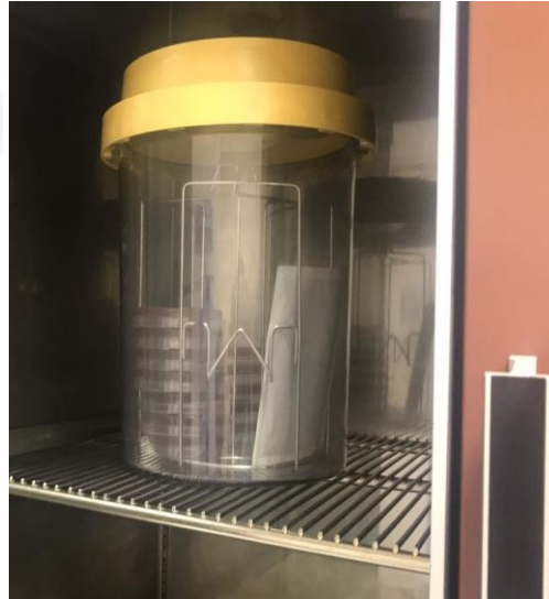
Figura 16. A. Jarra de anaerobiosis, generada con sobre GasPak™ EZ, y/o c GasPak™, B. Jarra de anaerobiosis incubada a 37±0.5°C.
