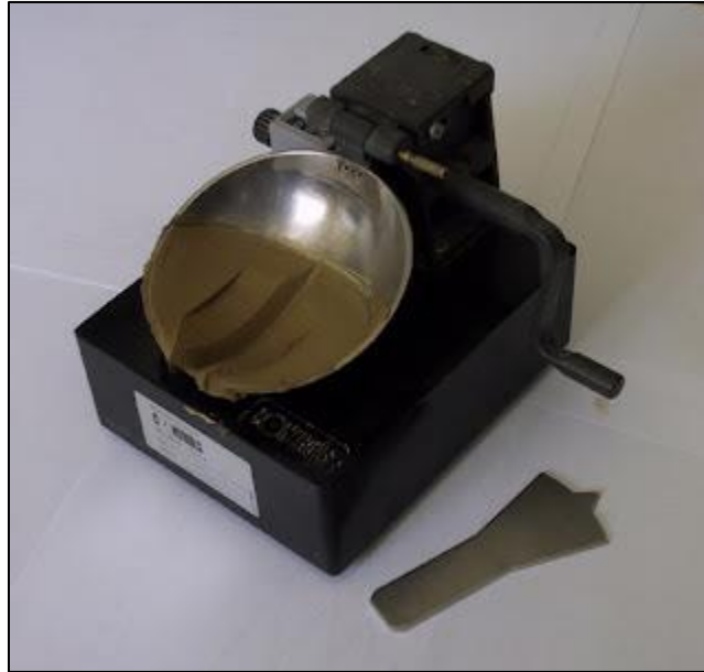
Figura 2.28. Copa de Casagrande con una muestra de suelo cortada por el ranurador (Vannia, 2012).
