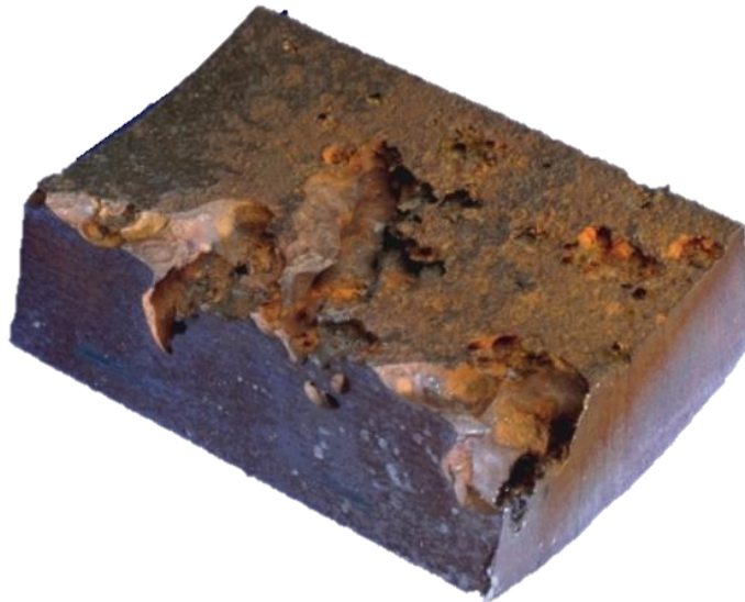
Figura 10. Ataque de corrosión local en oleoducto (Nyborg y Dugstad, 2002).
