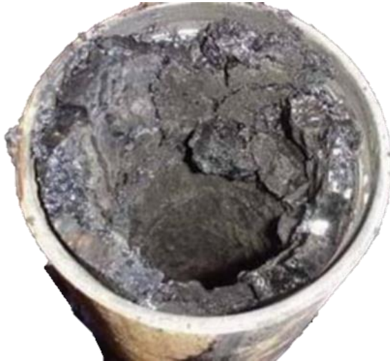
Figura 4. Depósito de asfaltenos en una tubería (Goual, 2012).
