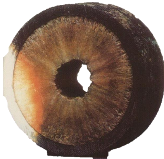
Figura 3. Ejemplo de depósitos de parafina en tubería (Singh et al., 2000).
