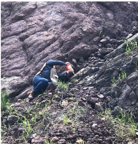
Ilustración 53 Prueba con martillo Schmidt en zona 1.
