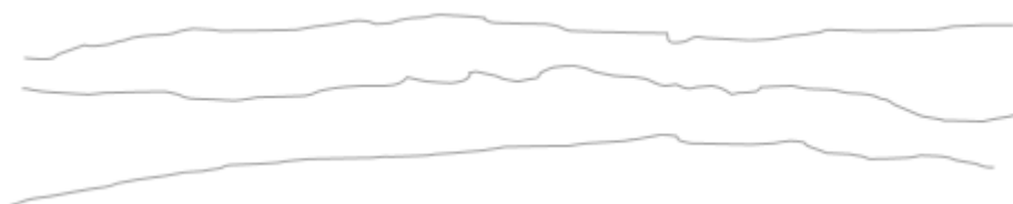
Ilustración 55 10 cm de la superficie de las discontinuidades, de arriba hacia abajo zona 1, zona 3 y zona 4
