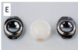
(E) se muestra una prótesis removida con inicio de falla por desgaste similar a casos previos (Van-Ooij et al., 2003).
