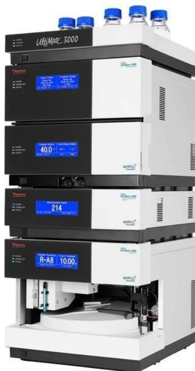
Figura 15. HPLC Equipo de cromatografía de líquidos de alta eficacia. Thermo Fisher Ultimate 3000. En este estudio se utilizó un cromatógrafo como éste en configuración de nanoflujo (250 nL/min). 39
