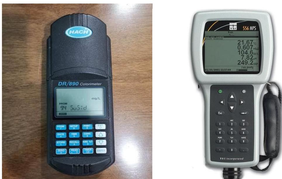
Figura 9. Colorímetro Hach DR /890 y multiparámetros o multisonda marca YSI professional empleados en la determinación de parámetros.
