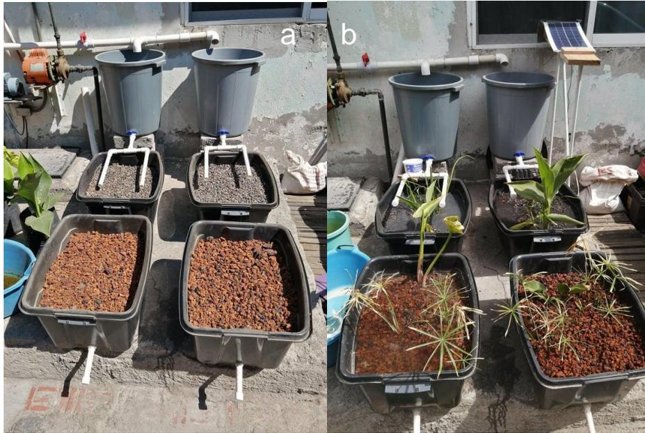
Figura 15. Puesta en marcha (abril) de los sistemas humedal testigo y humedal con electrodos (localizada en la parte superior) sin ejemplares (a) y con ejemplares (b) de *Canna Indica* y *Typha* sp. en el submódulo 1, así como, *Cyperus alternifolius* y *Zantedeschia aethiopica* en el submódulo 2.
