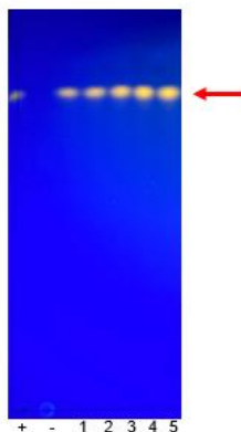
Figura 42. CCF del compuesto recuperado por CCF preparativa. Control positivo (+) estefimicina B, (-) medio de cultivo, carriles 1- 5 corresponden a las muestras obtenidas. Elución con cloruro de metileno, acetona, hexano y metanol en proporción 30:10:3:2 y observado a \lambda 365 nm. La flecha roja indica la presencia de la estefimicina B.
