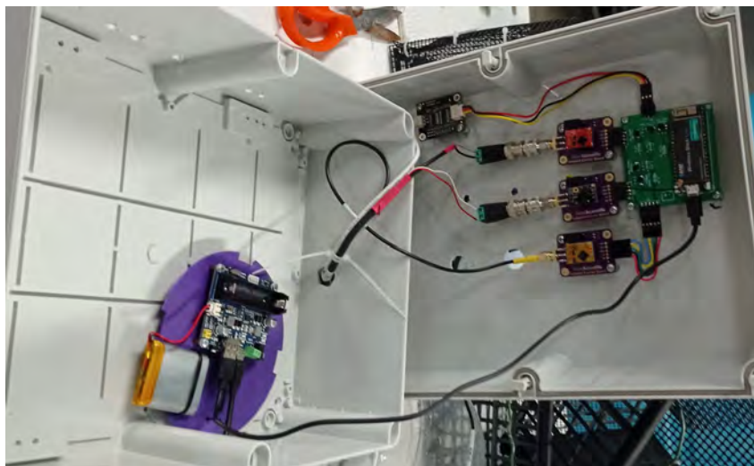
Figura 5.31: Adaptación del sistema recolector de datos en un gabinete.
