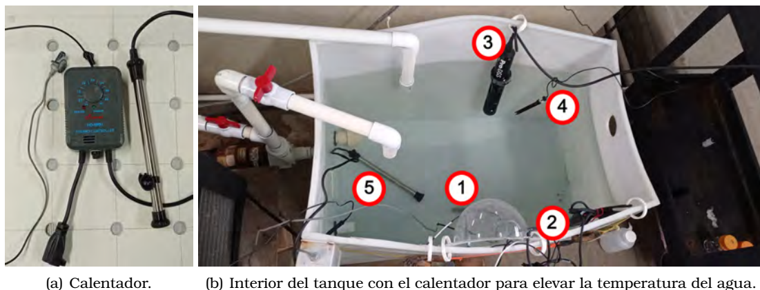
Figura 5.7: Integración del calentador al sistema de experimentación. Sonda del chiller para detectar la temperatura del agua (1), sondas que conforman al prototipo (2), cabezal de la multiparamétrica ProDSS YSI (3), sonda del medidor de pH Aqua Medic (4) y resistencia del calentador (5).
