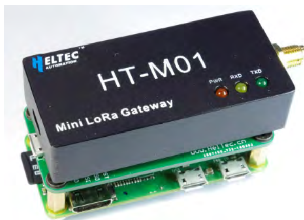
Figura 3.8: Gateway HT-M01 controlado a través de SPI por una Raspberry Pi ZERO W [Obtenido de [1]].
