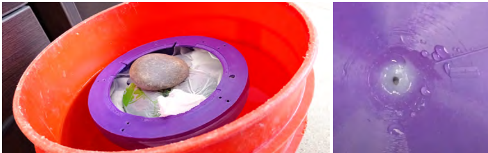
(a) Arreglo propuesto para probar la flotabilidad e impermeabilidad del cuerpo impreso. (b) Problema de filtración detectada en el cuerpo impreso.
