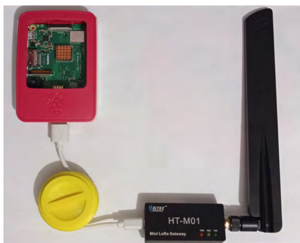
Figura 3.9: Gateway HT-M01 controlado a través de USB por una Raspberry Pi modelo 3B+.
