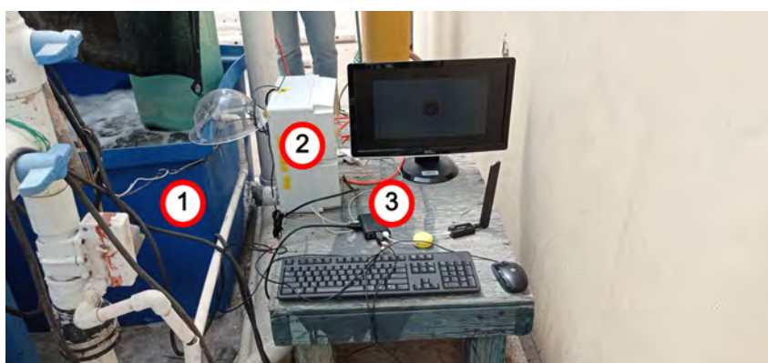
Figura 5.32: Configuración del escenario de experimentación realizada durante el experimento en el cultivo de camarones. Tanque de compensación (1), sistema de recolección de datos (2) y gateway (3).
