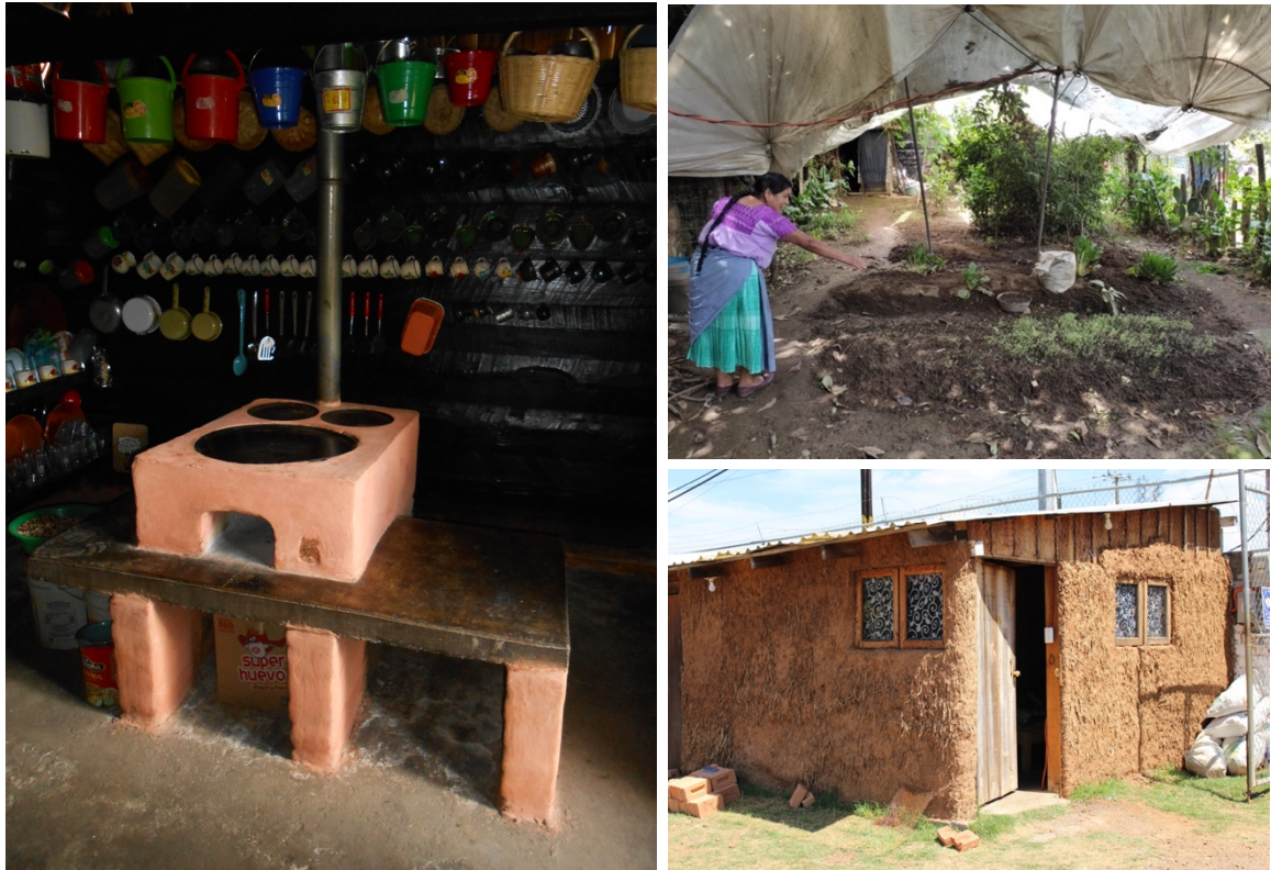
Figura 1. Estufa mejorada de leña tipo Patsari. Figura 2. Huerto traspatio. Figura 3. Técnica de bioconstrucción en ejecución mediante tierra y paja. Fuente: elaboración propia.
