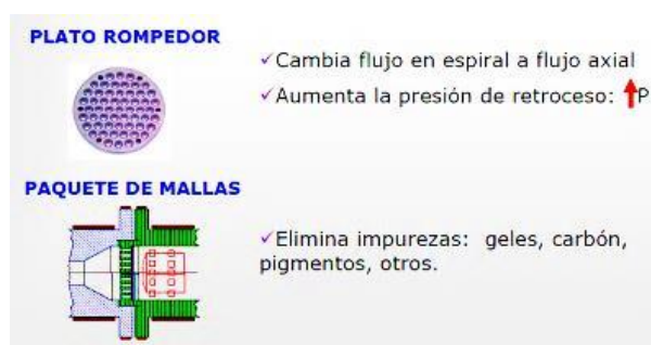
Figura 3.4 Plato Rompedor y Paquete de Mallas. [13]
