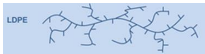
Figura 2.2 Ramificación del polietileno de baja densidad. [5]
