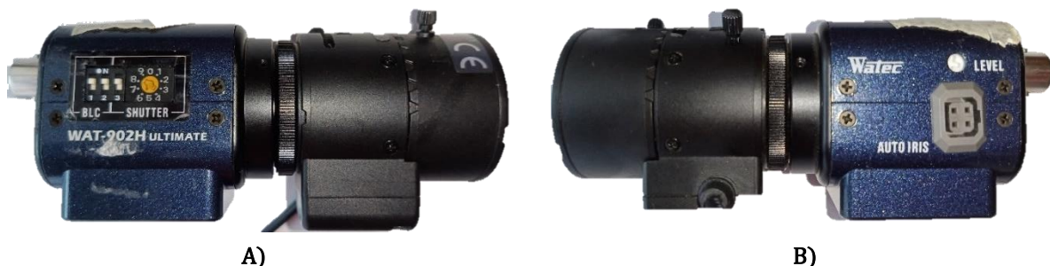
Figura 4. Cámara WAT-902 H2 Ultimate (EIA) con lente de 1/3” y distancia focal de 3 a 8 mm. A) Vista lateral derecha. B) Vista lateral izquierda.
