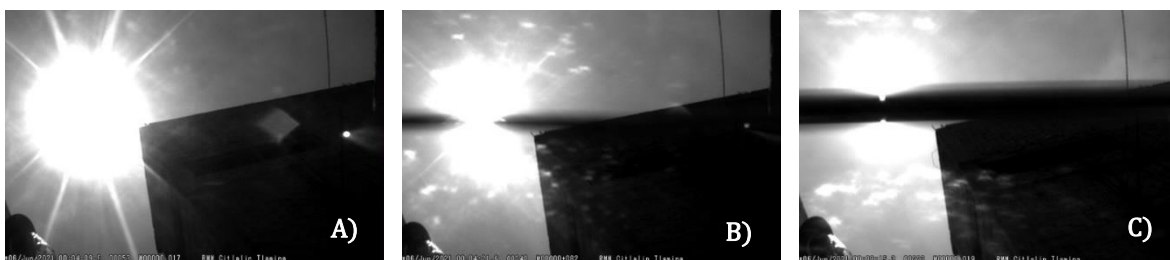
Figura 48. Vista del Sol con y sin el coronógrafo. A) Vista del Sol sin el coronógrafo. B) Vista del Sol usando una barra de 0.7 mm. C) Vista del Sol usando una barra de 2 mm.
