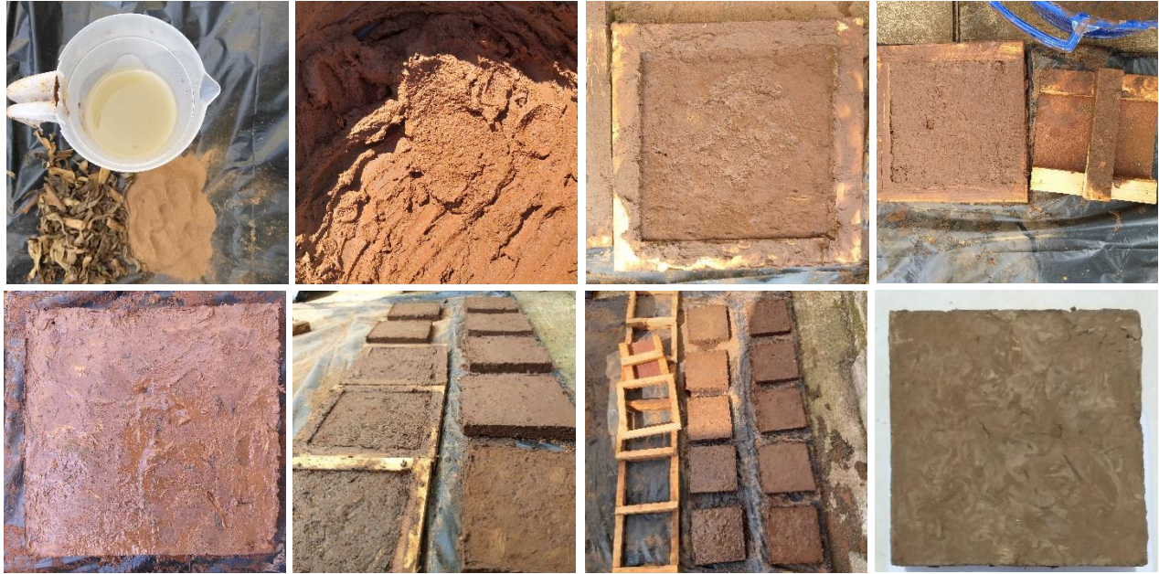
Figura 51: Proceso de elaboración de probetas para pruebas de 15cm x 15cm x 2.5cm
