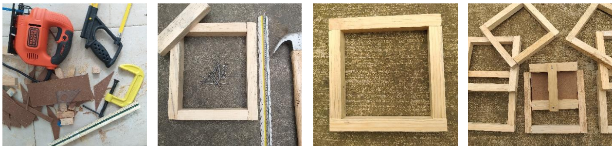
Figura 50: Proceso de elaboración de molde de madera para probetas de experimentación de 15cm x 15cm x 2.5cm
