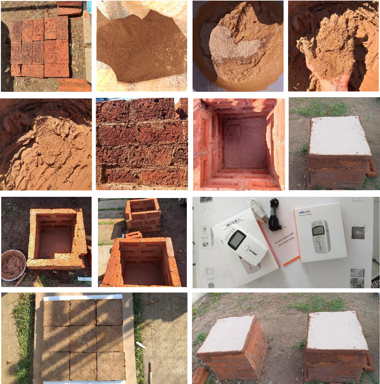
Figura 52: Proceso de la elaboración de las cabinas las cuales en su interior con recubrimiento y sin recubrimiento, así como cada una cuenta son un Data Logger que tomara mediciones de humedad y temperatura.
