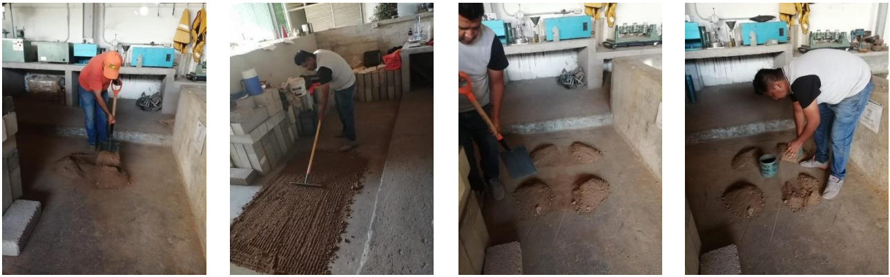
Figura 43: Pruebas de cuarteo, disgregado y peso volumétrico.
