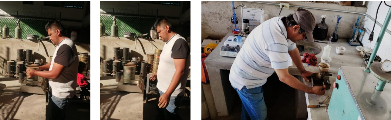
Figura 44: Pruebas de granulometría y límites de plasticidad.
