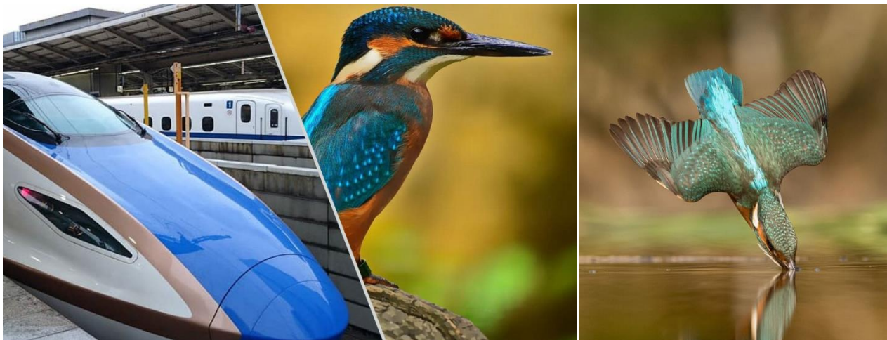
Figura 11: Tren bala de Japón está inspirado en el pico del Ave martín pescador.
