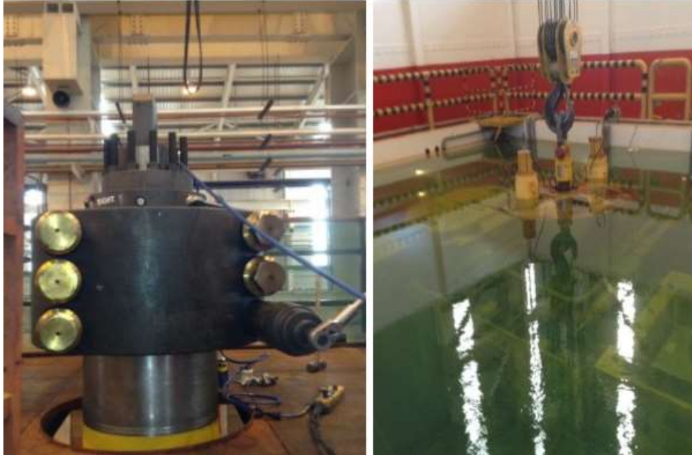
Figura 4.4 Prueba de Spool Body 49
