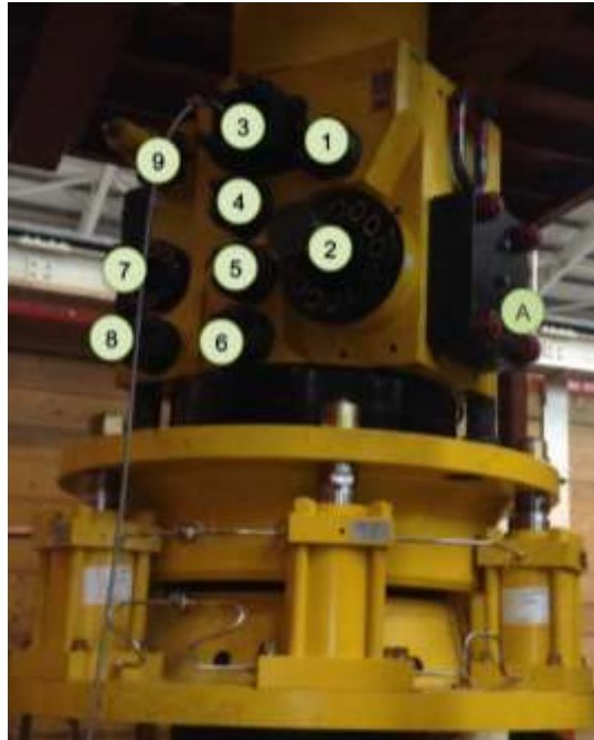
Figura 4.5 Bonetes para válvulas de la parte frontal 50
