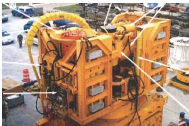
Figura 2.4 Paquete de desconexión de emergencia (EDP) 30
