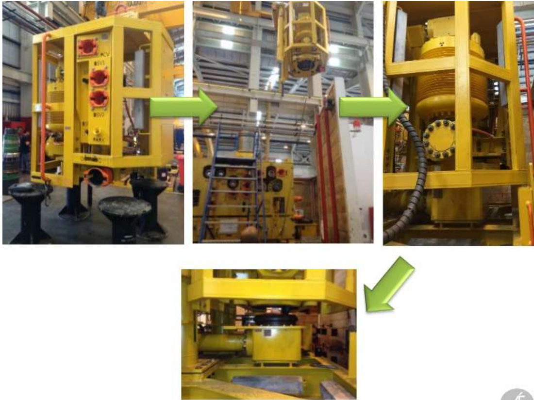
Figura 4.15 Instalación de RPM 60
