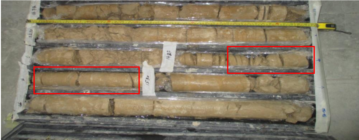
Figura 4.8.- Núcleo de material extraído durante la exploración en donde se realizó la prueba de Elastómetro a 14.80 m de profundidad (rectángulo rojo)
