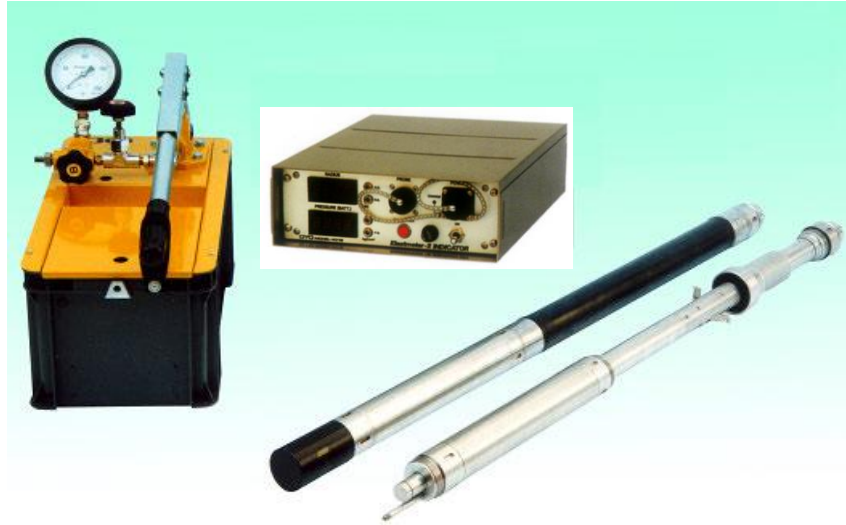
Figura 3.1 Elastómetro – 2, Sonda Modelo-4180 (der), Lector digital 4018 (centro) y bomba de mano de alta presión (izq). (Tomada de ficha técnica, OYO Corporation)
