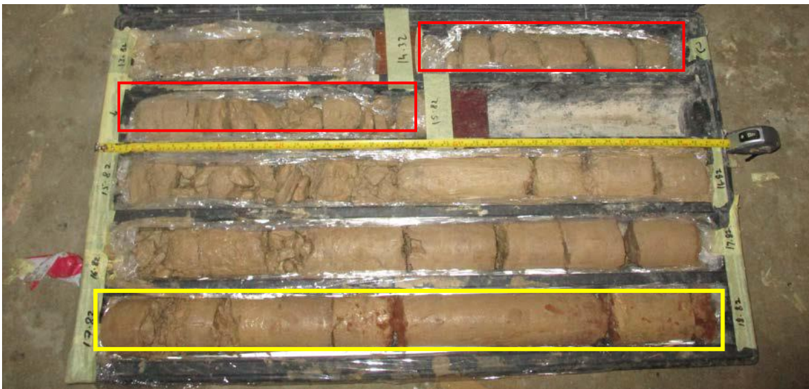
Figura 4.11.- Muestras de roca cerca de la profundidad de las pruebas a 15 m y 18 m en el sondeo BH-02 de la zona II
