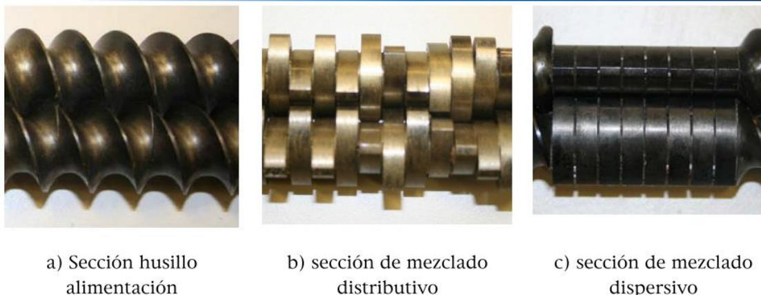
Nota: Se presentan ejemplos de configuración de secciones de husillos conforme al tipo de mezclado y etapa del proceso, ya sea alimentación, distribución o dispersión, obtenido de Villanueva, 2009, p. 289.
