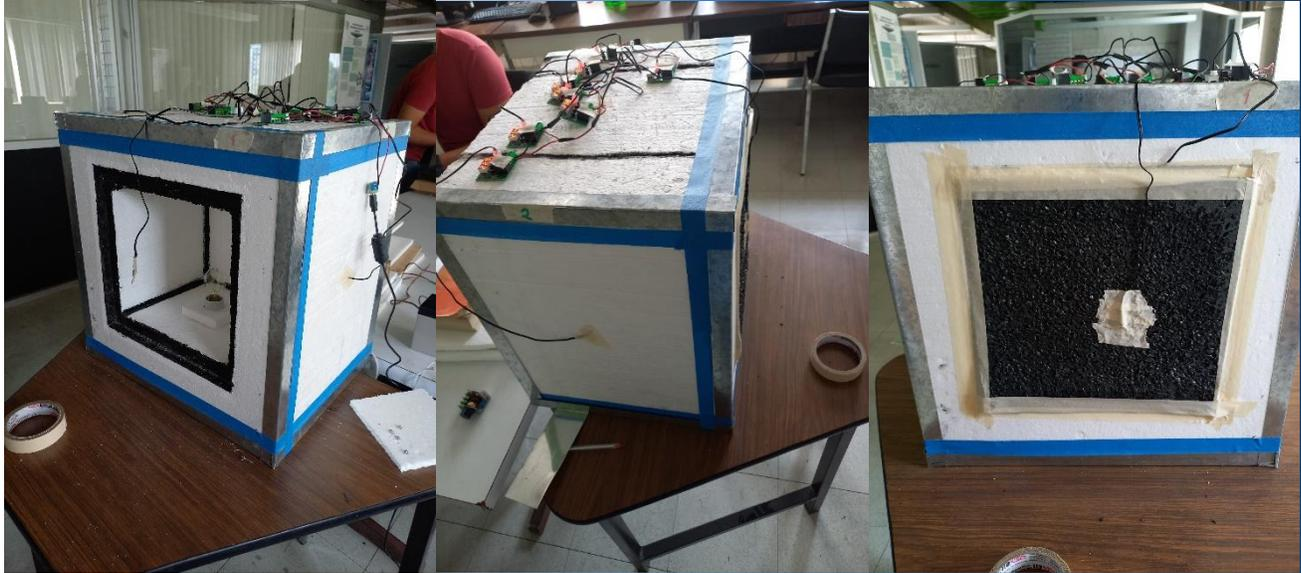
Nota: Se muestra el proceso de prueba en la cámara adiabática para determinar el coeficiente de conductividad térmica del material compuesto, se realizaron mediciones tanto al interior como al exterior de la cámara para monitorear el comportamiento térmico en un promedio de 5 horas, autoría propia.
