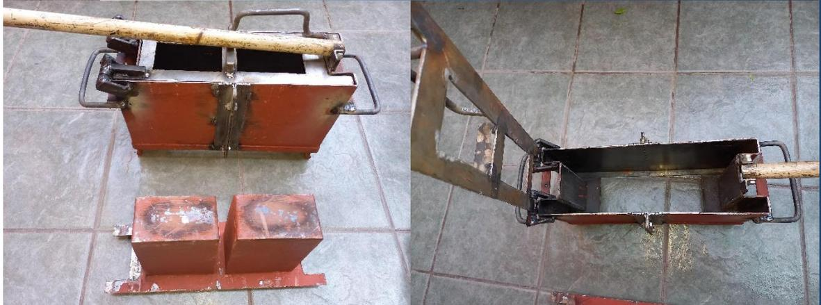
Nota: En las imágenes se muestran las piezas que conforman el molde para la fabricación del prototipo de panel, consta de 2 piezas exteriores y una pieza interior, autoría propia.
