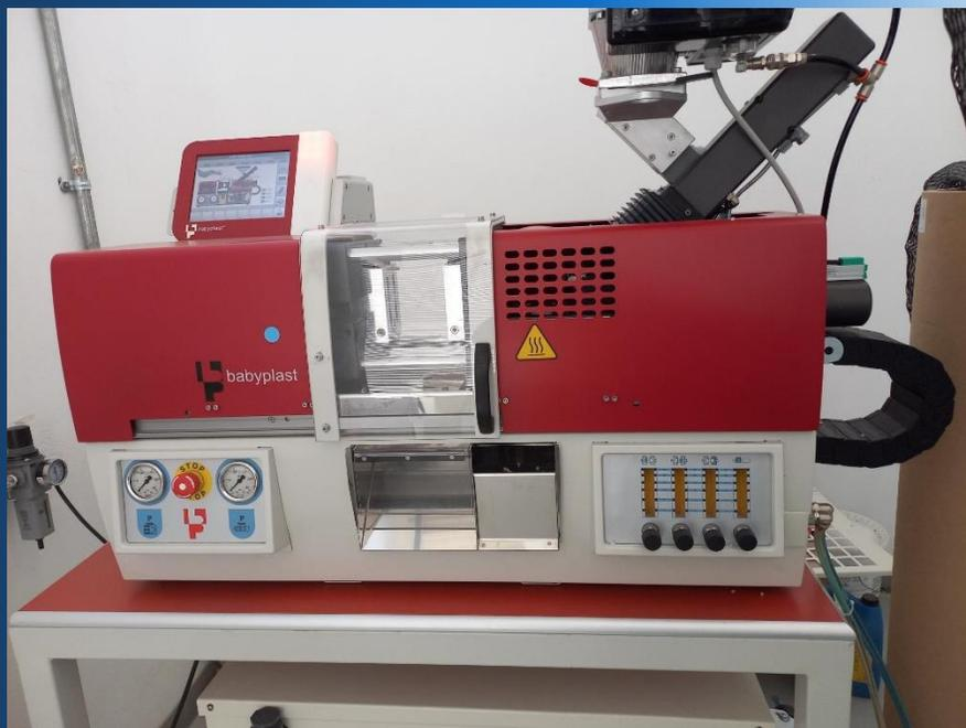
Nota: Las probetas se fabricaron con apoyo de un equipo de inyección de polímeros Babyplast 610P, con la finalidad de cumplir con las dimensiones que especifica la norma y producir piezas de mejor calidad, autoría propia.
