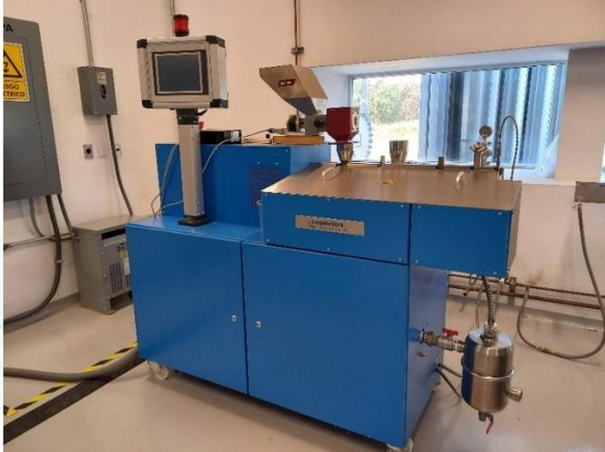
Nota: Equipo de extrusión de doble husillo para la fabricación de probetas del compuesto polímero - arcilla
