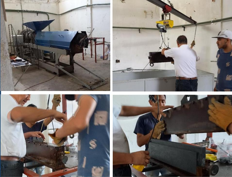
Nota: En las imágenes se observa el proceso que se lleva a cabo en la planta de la empresa Bloqueplas para fabricar las piezas que configuran los muros de espacios arquitectónicos, este sistema es más económico que el de extrusión lineal, aunque es un proceso más tardado y manual, autoría propia.
