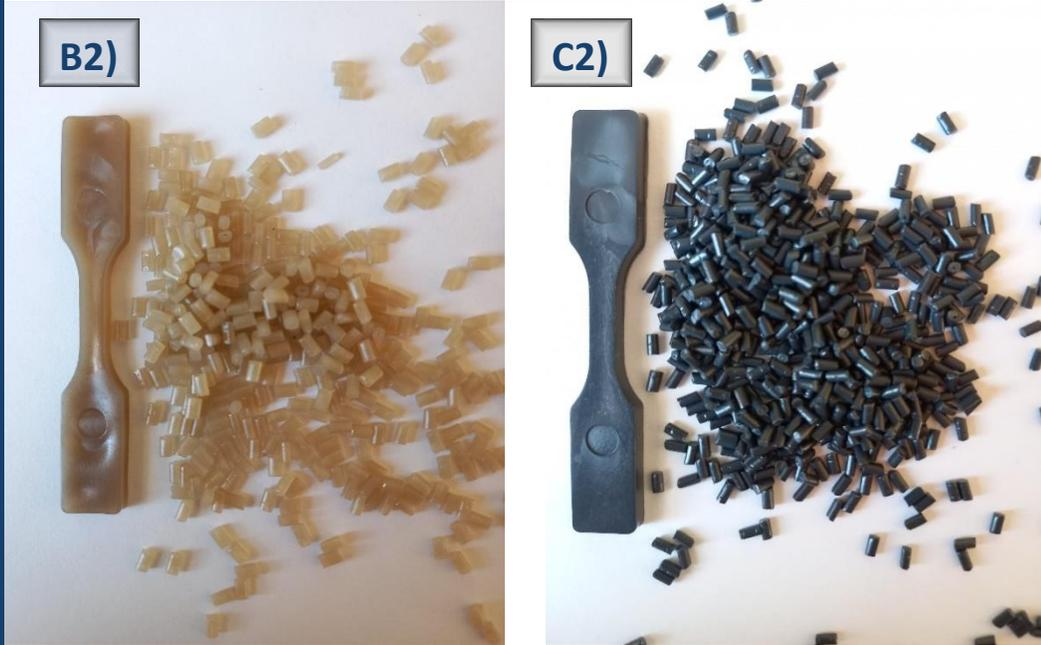
Nota: En las imágenes se observan las probetas fabricadas por un proceso de inyección y el pellet obtenido por el proceso de extrusión.
