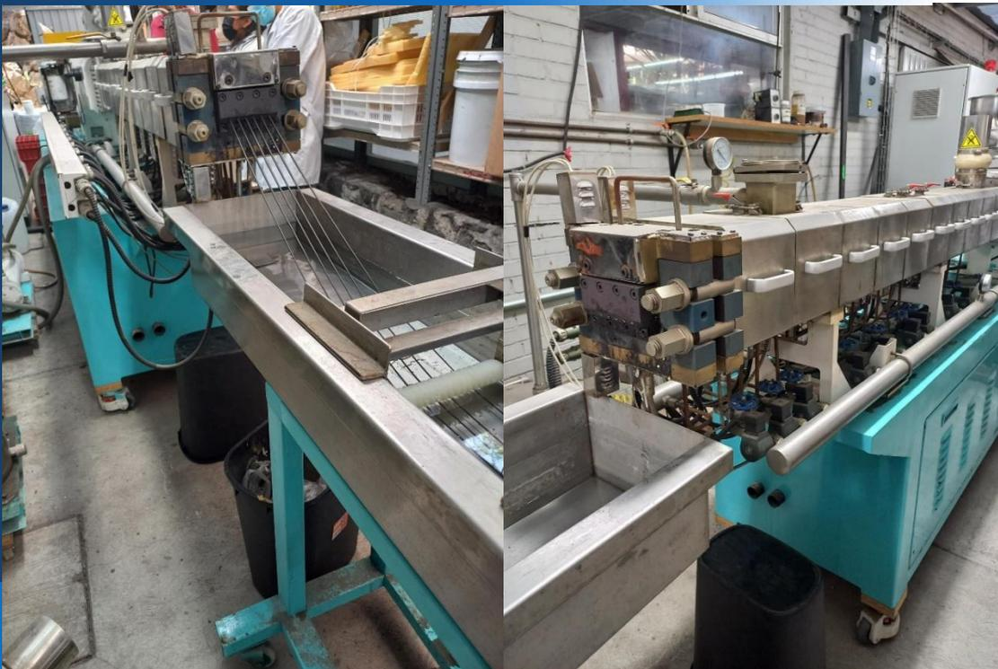
Nota: Se realizó el proceso de extrusión de la matriz de resina de polietileno de alta densidad (B) y la matriz de polietileno de alta densidad reciclado negro (C), por medio de otro equipo de extrusión de doble husillo y se aditaron arcilla modificada, se cambió el agente de acoplamiento por Fusabond E-265 con base en Anhídrido Maleico, elaboración propia.
