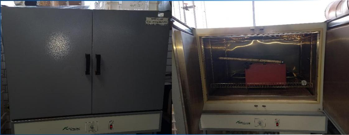
Nota: En las imágenes se presenta el proceso de fusión del plástico dentro del molde, se realiza en un horno de calentamiento industrial de resistencias, autoría propia.
