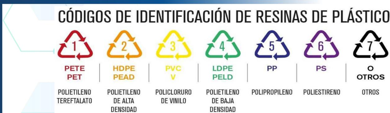
Notas: Se presenta la simbología de clasificación de los 7 tipos de plástico conforme al Código de Identificación de plásticos, con la finalidad de facilitar los procesos de reciclaje de los mismos, del Estudio de nuevas tecnologías de la construcción con bloques de materiales plásticos reciclados por Betancurt F. 2019.
