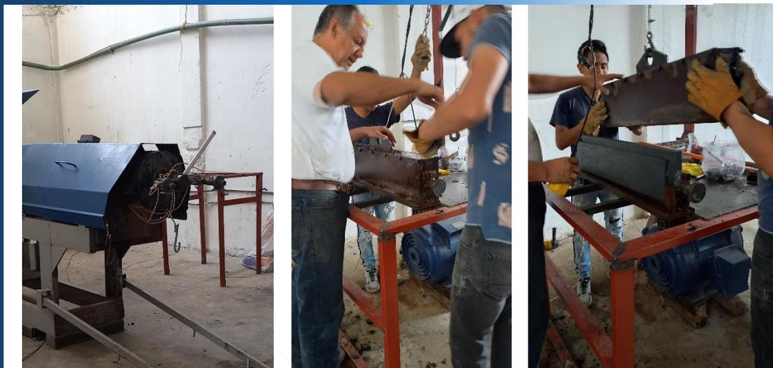
Nota: En las imágenes se presenta un proceso de extrusión e inyección a un molde metálico el cual puede ser una alternativa para fabricar el panel modular debido a la masividad del elemento y a la cantidad de material que se requiere para la fabricación de las piezas, autoría propia.
