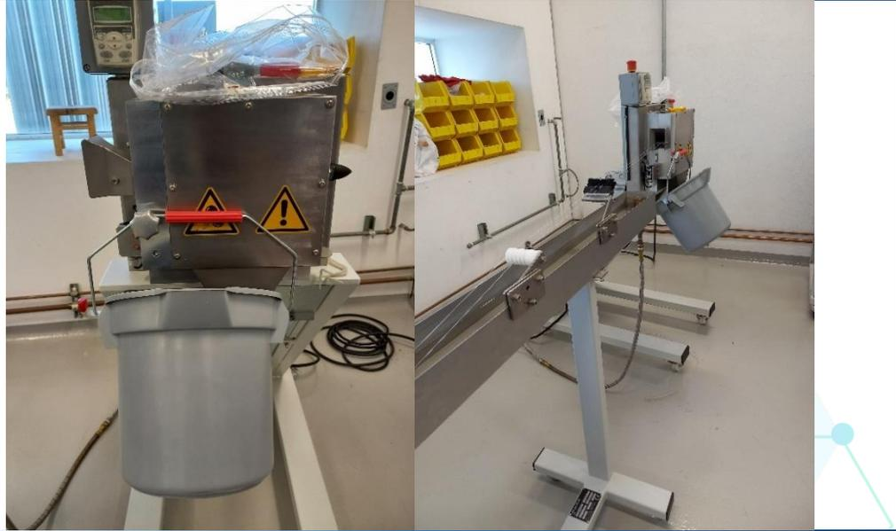
Nota: Equipo de peletizado, se usó para convertir el filamento en pequeños gránulos o pellets, con el objetivo de poder manipularlo para la fabricación de probetas.
