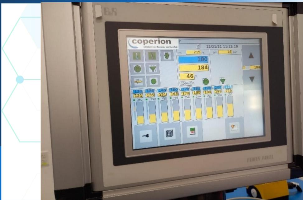
Nota: Se muestran los parámetros de temperaturas en las diferentes fases del cañón iniciando con 120°C hasta llegar a los 215°C al final en la zona del cabezal para la salida del material, elaboración propia.
