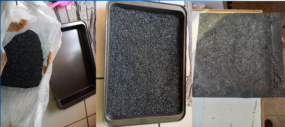
Nota: Se muestra el proceso de fabricación de la probeta de 29 x 29 cm, por medio de fundición en horno a 200°C sobre molde metálico, autoría propia.
