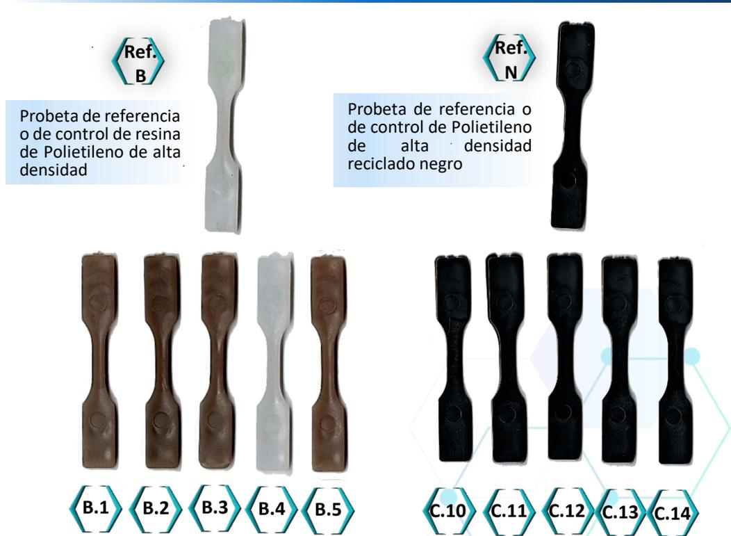
Nota: En el esquema se presentan las variantes de las probetas fabricadas para la familia "B" y "C" correspondientes a las proporciones de materiales indicadas en la tabla 3.7, el consecutivo de las probetas 6, 7, 8 y 9, corresponden al material que se descartó, autoría propia.
