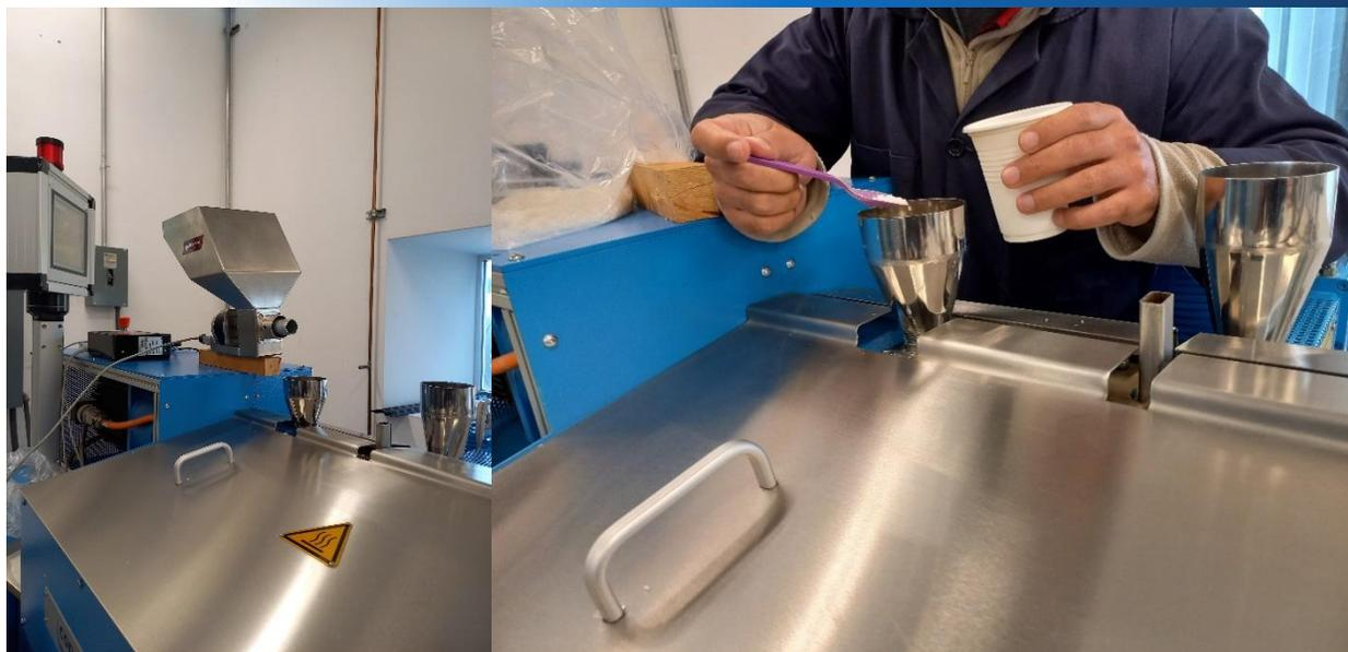
Nota: En la imagen se presenta el proceso de adición manual de la arcilla para integrarla al cañón de la extrusora, mientras que el HDPE se coloca por medio de un dosificador para propiciar que el material se agregue de forma regular, elaboración propia.
