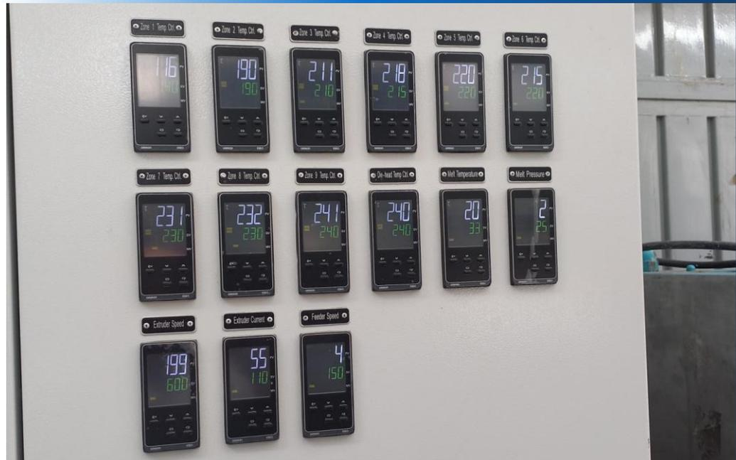
Nota: En el gráfico se observan las temperaturas en cada una de las zonas al interior del equipo de extrusión, así como las presiones y velocidades que se manejan en el proceso, elaboración propia.
