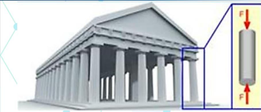
Notas: Un cuerpo está sometido a un esfuerzo de compresión cuando se le aplican fuerzas en el mismo eje y provocando un abombamiento en su parte central y reduciendo su longitud inicial. Obtenido de elementos amovibles y fijos no estructurales, <http://amoviblesio.blogspot.com/2015/11/compression-traccion-flexion-torsion.html>, 22 de noviembre de 2015.
