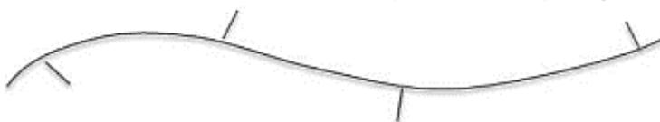
Notas: En el gráfico se observa la representación de una estructura simple de Polietileno de alta densidad, obtenido de <https://goo.gl/iHdXoC>, 12 de agosto de 2021.
