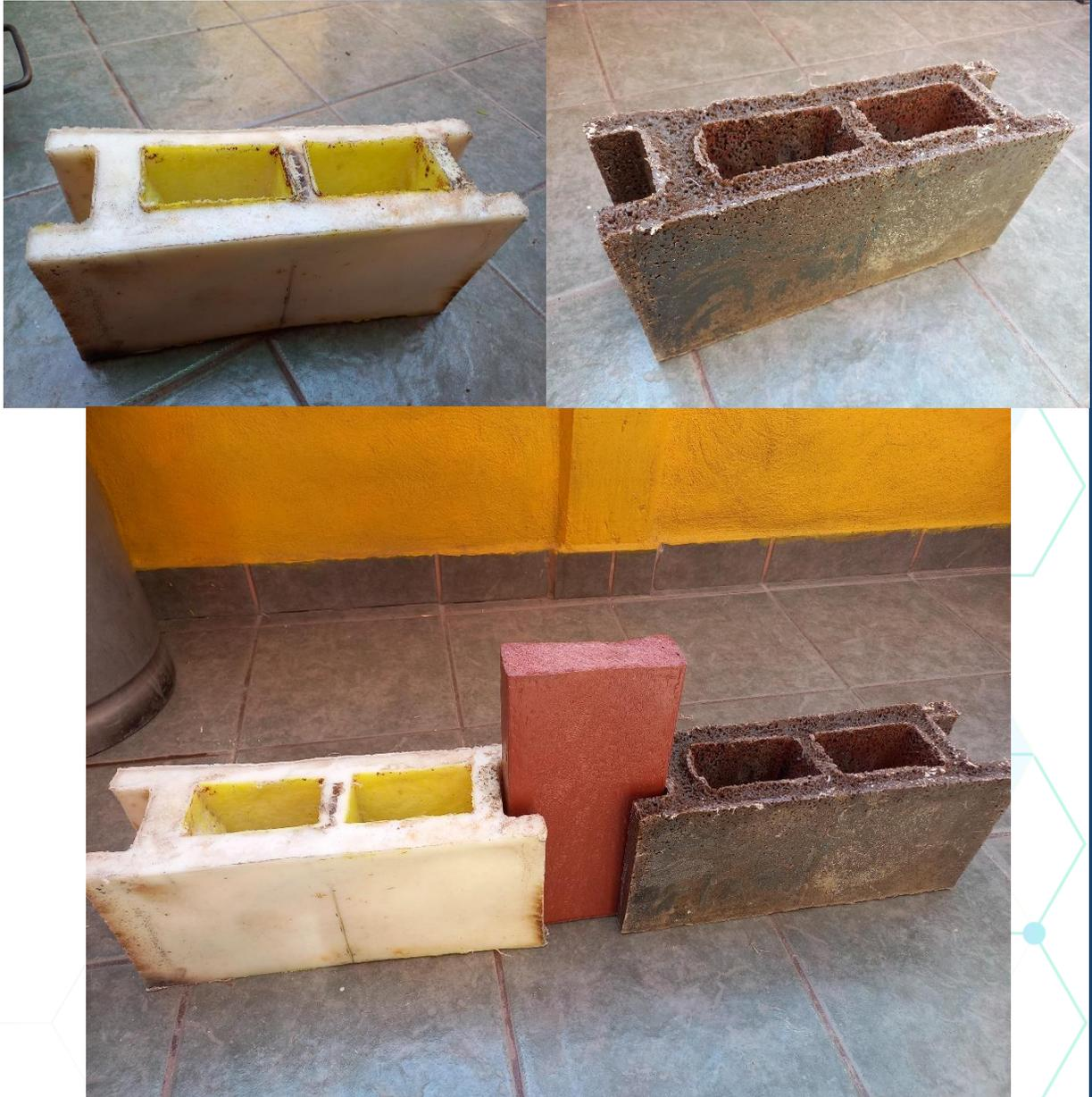
Nota: En las imágenes se muestran los prototipos resultantes del proceso descrito líneas arriba, y el criterio de ensamblaje para empotrarlos por medio de un sistema de anclaje en seco, autoría propia.
