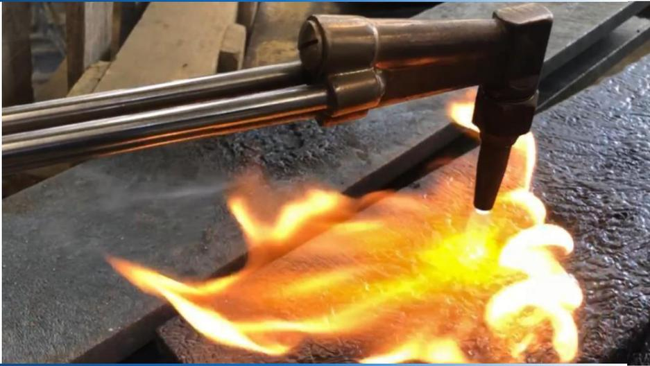
Nota: En el gráfico se puede observar una prueba de fuego a 500° C sobre un material compuesto de polímeros utilizados para la construcción, a este material se le añadió carbonato de calcio como protección contra el fuego, obtenido de Grupo Bloqueplas de México, 2021, p. 10.
