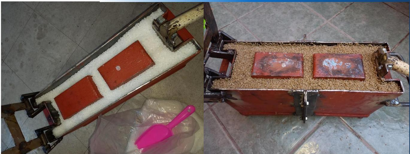
Nota: Se muestran las imágenes del proceso de saturación del molde con material plástico, resina de polietileno de alta densidad (lado izquierdo) y compuesto polietileno de alta densidad – arcilla (lado derecho), autoría propia.
