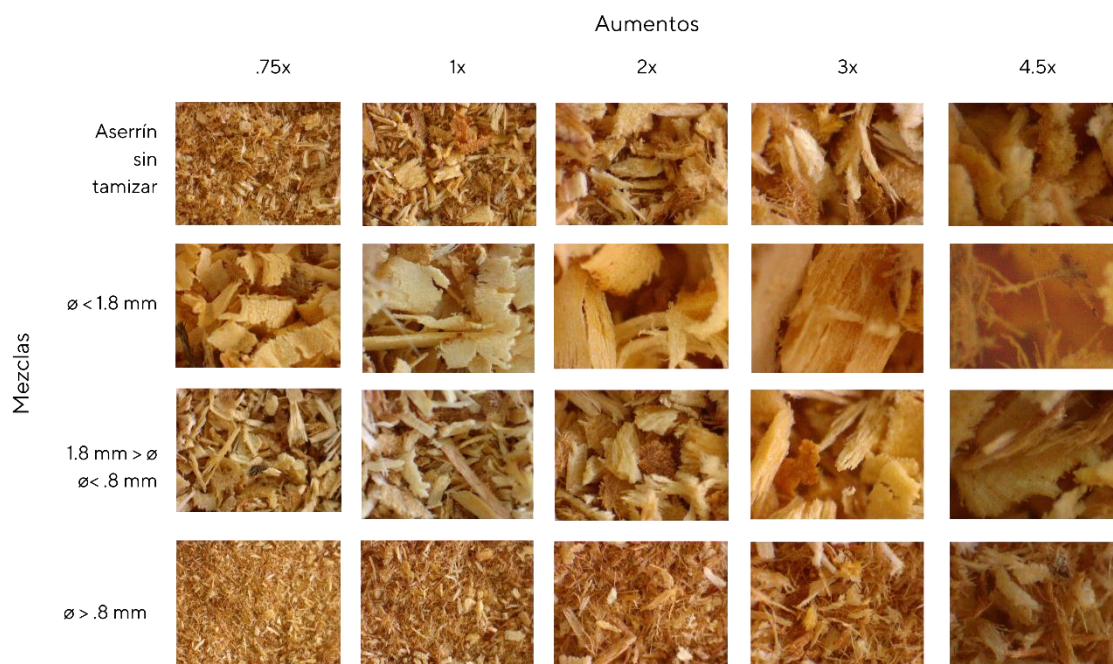
Imagen 5.2 Imágenes microscópicas de los cuatro grupos de aserrín obtenidos con diferentes aumentos
