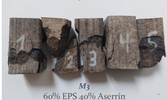
Imagen 6.4 Muestras posteriores a la prueba de compresión
