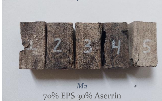
Imagen 6.4 Muestras posteriores a la prueba de compresión
