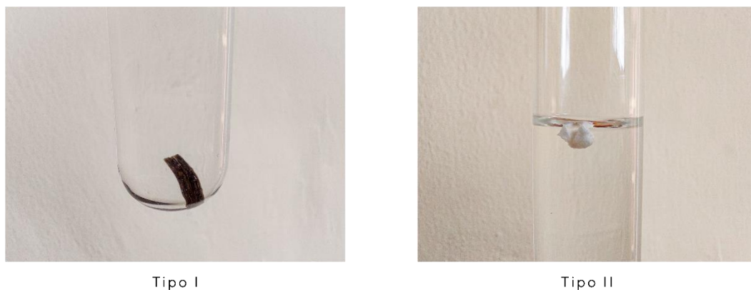
Imagen 5.1 Muestras de REPS disolviéndose en cloroformo
