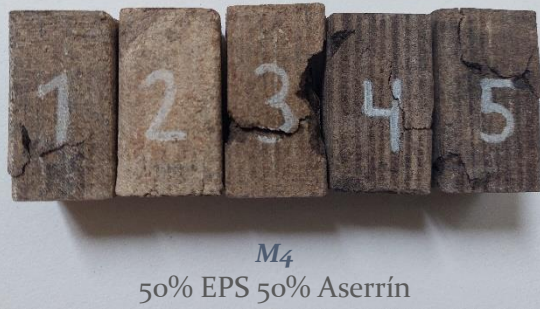
Imagen 6.6 Muestras posteriores a la prueba de compresión
