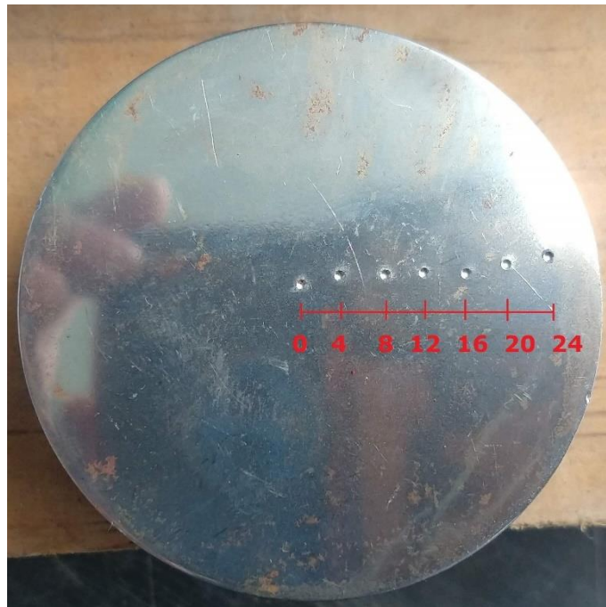
Figura 18. Distribución de los ensayos de dureza en las probetas (dimensiones en mm).
