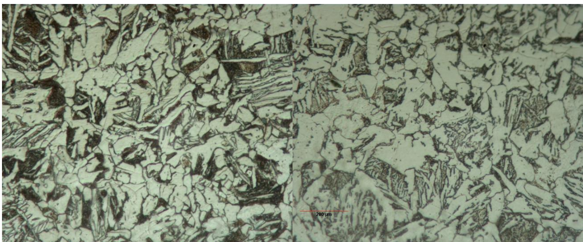
Figura 25. Microestructura del acero SAE 1018 con tratamiento térmico de temple y revenido alto (550°C). En la figura de la izquierda se tiene el resultado de la probeta A y de lado derecho el de la probeta B, en ambos casos se observa una microestructura formada principalmente por ferrita Widmanstätten y martensita revenida. Tomadas a 500X y atacadas con nital al 5%.
