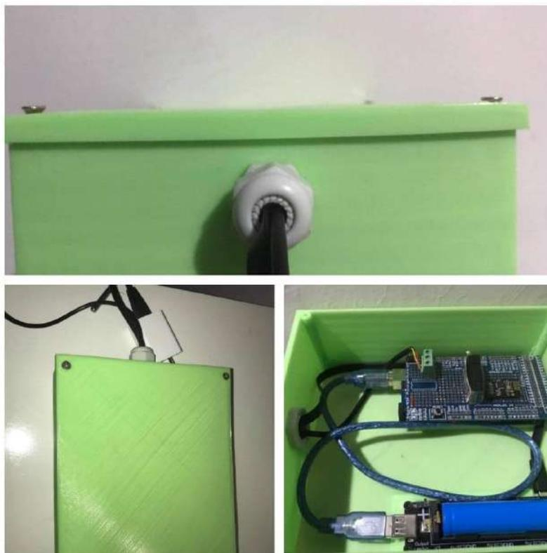
Figura 1: Adquisidor de datos basado en Arduino
