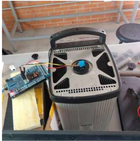
**Figura 3.3:** Cámara de temperatura constante
