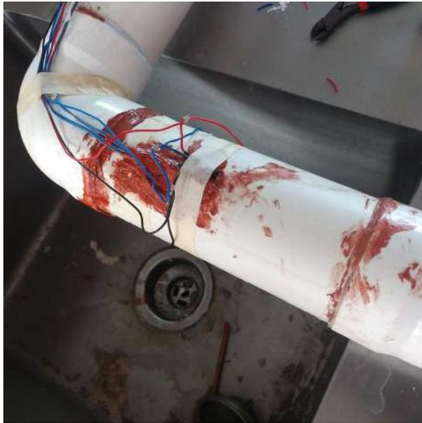
**Figura 3.16:** Instalación de los sensores DS18B20
