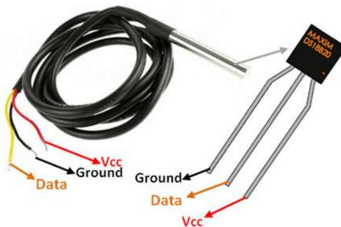
**Figura 2.10:** Sensor digital de temperatura DS18B20.
