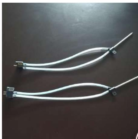
**Figura 3.9:** Sensores tubo Pitot.
