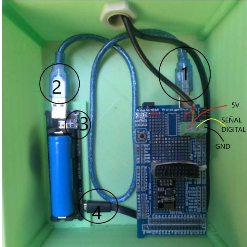
Figura 3: Guía de conexiones
