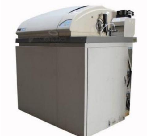
Figura 3.8. Fotografía de un espectrómetro de masas Perkin Elmer Sciex Elan 6100 como el utilizado en el presente trabajo (tomado de [www.conquerscientific.com](http://www.conquerscientific.com)).
