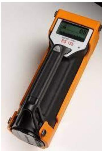
Figura 3.4. Fotografía del escintilómetro modelo RS-125 utilizado en el presente trabajo.
