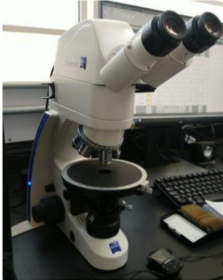
Figura 3.5. Fotografía del microscópico Primotech modelo Carl Zeiss S/N 3156000314 utilizado en el presente trabajo.
