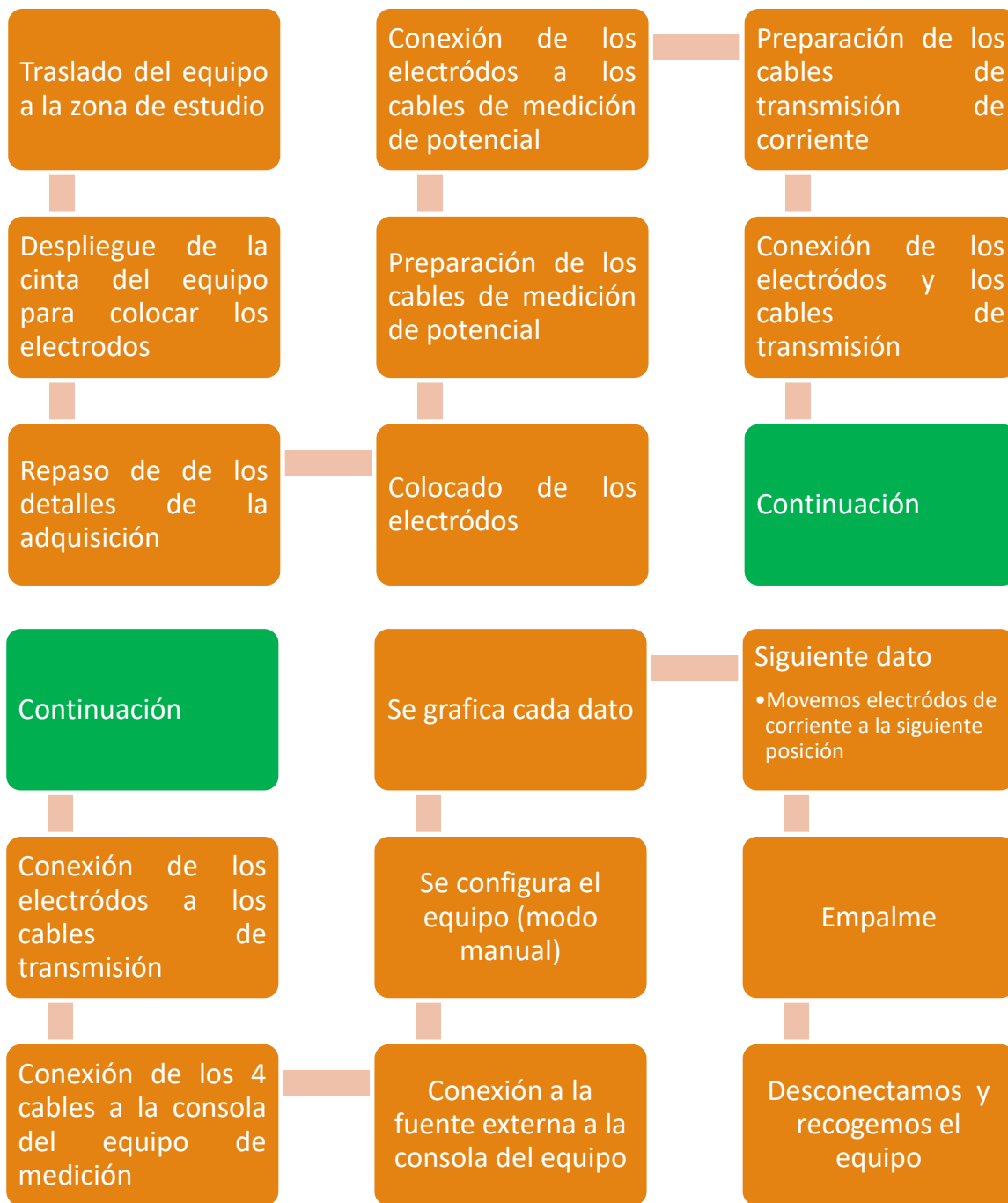
Figura 68. Proceso general del empleo del equipo en la exploración geoelectrica en 1D.
