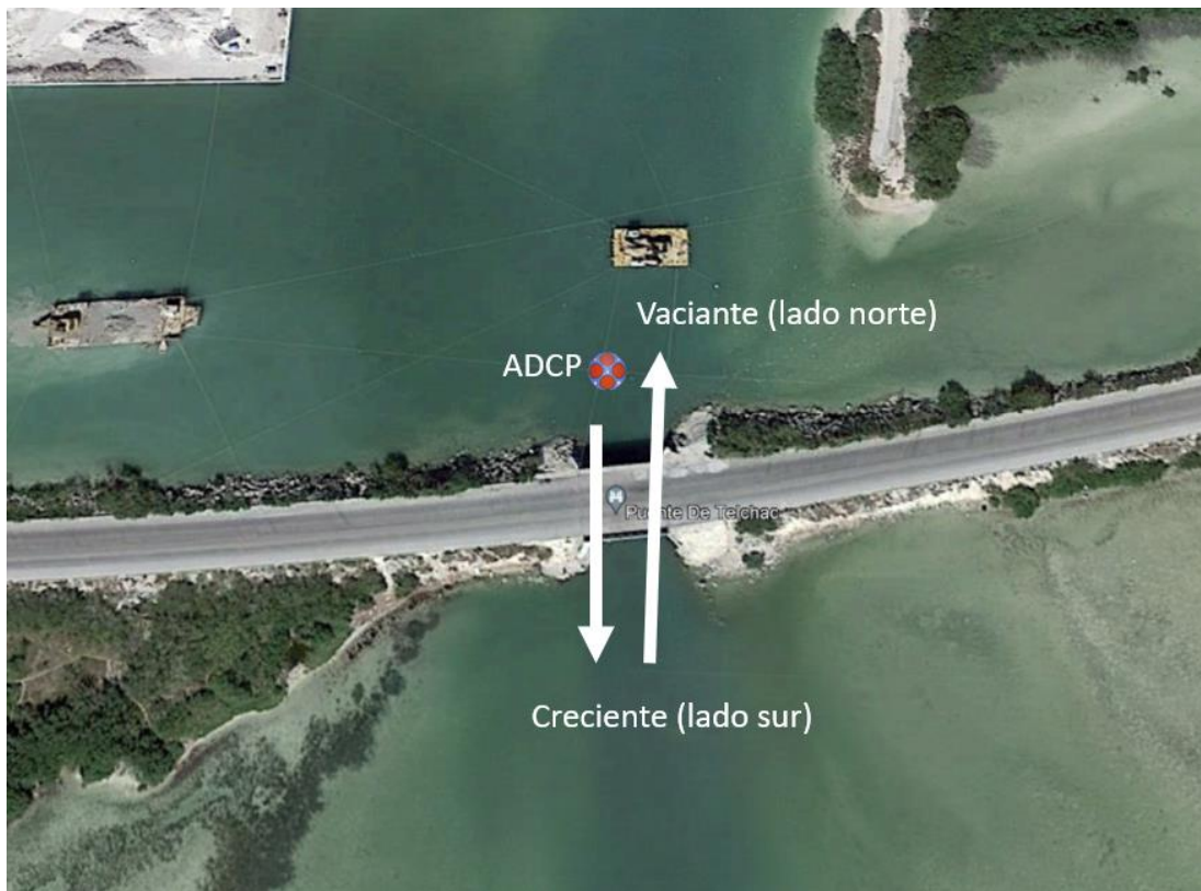
Figura 27. Diagrama de ubicación de instalación de ADCP en la zona de estudio (Cuen Ulloa,2022)
