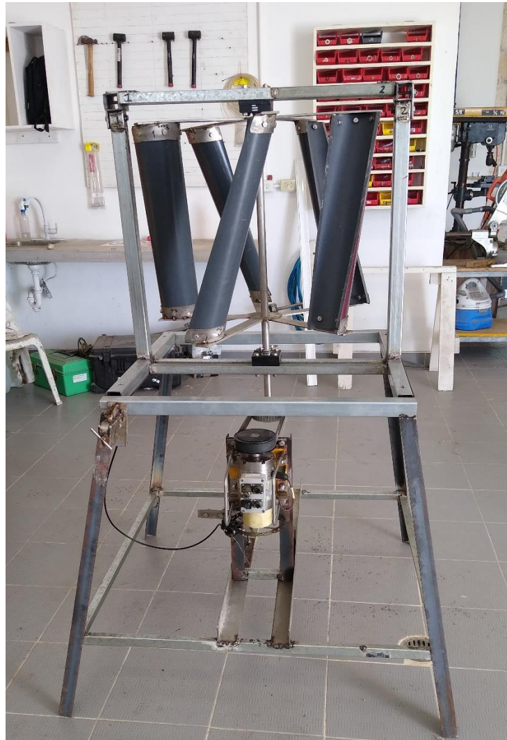
Figura 11. Banco de pruebas y turbina helicoidal con torquímetro y sistema de frenado.
