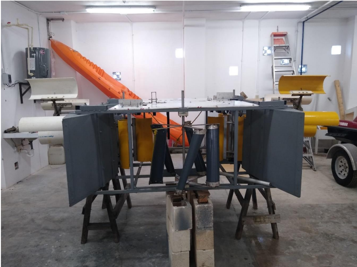
Figura 28. Vista de parte trasera del hidrogenerador con turbina helicoidal.
