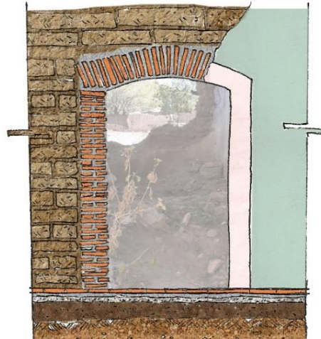
Ilustración 81 Detalle de muro y enmarcamiento de puerta. | Elaboración propia. 2020.
