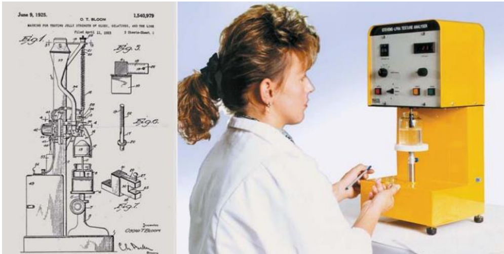
Figura 4. La medición de la fuerza del gel sigue siendo el parámetro más importante para la gelatina. Izquierda: el equipo original en la solicitud de patente de O. Bloom de 1925. Derecha: un moderno instrumento semiautomático (Schrieber & Gareis, 2007).
