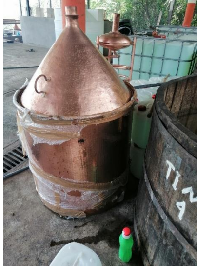
Figura 5.5 Equipo de destilación del fermentado.
