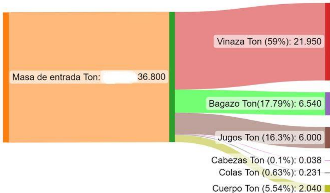
Figura 6.5 Diagrama de sankey del flujo de masa durante el proceso de obtención del mezcal.
