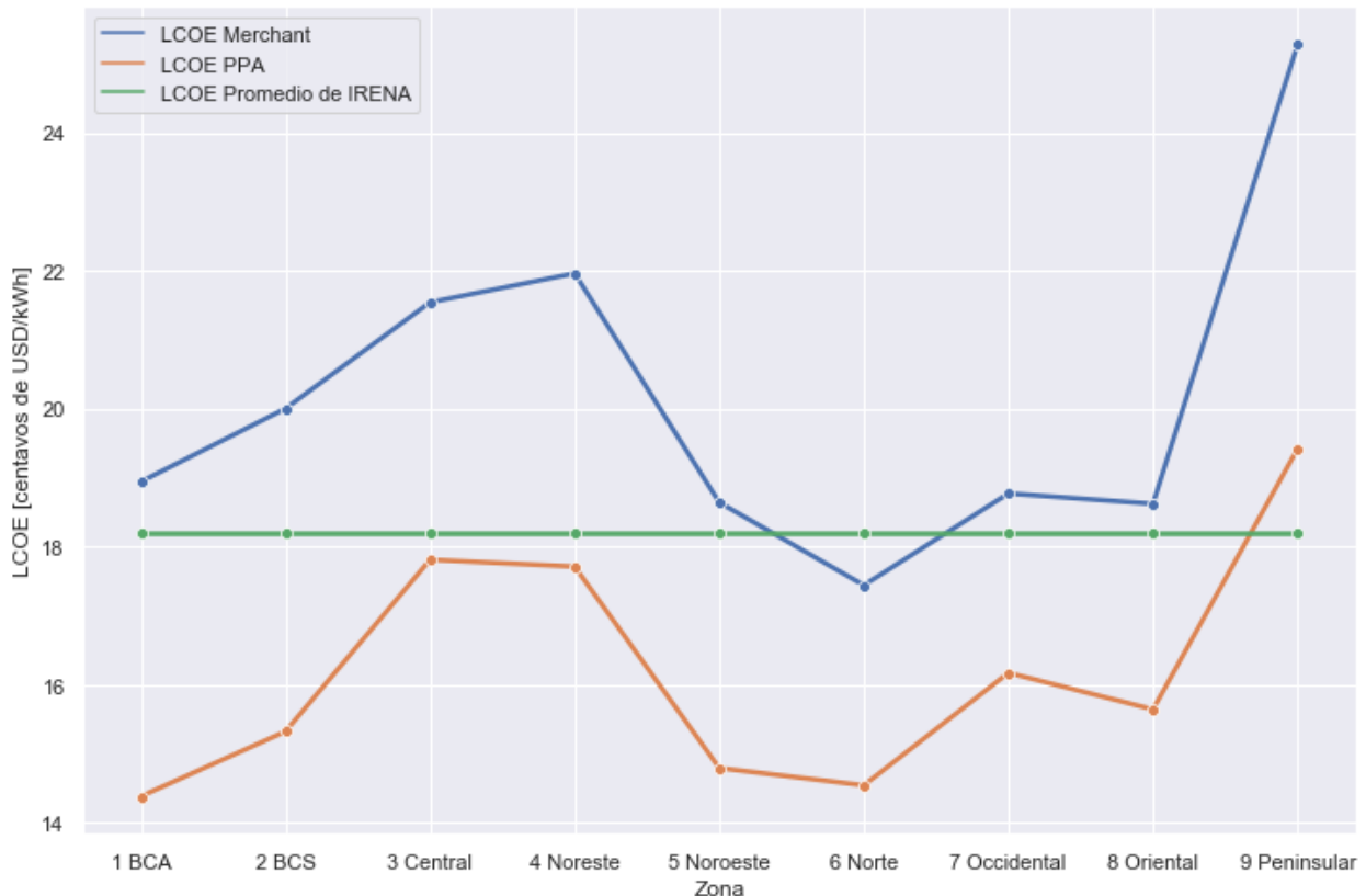
Figura 34. Comparación de costos nivelados de las centrales modeladas en modalidad merchant y PPA.
